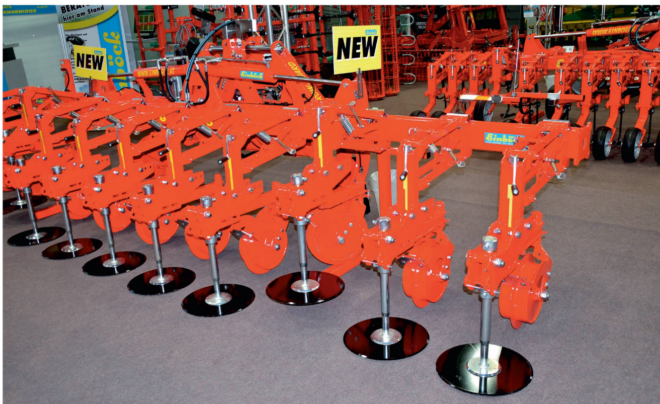
La bineuse à disques horizontaux tournant librement est une nouveauté sur le marché. Photo: Ruedi Hunger
