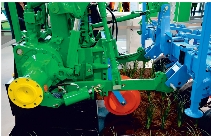
John Deere propose un système de guidage automatique consistant à commander la bineuse par l'intermédiaire des bras inférieurs du relevage arrière. Photo: Ruedi Hunger
