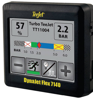
Cette commande de buse TeeJet permet la sélection de différents spectres d'épandage en fonction de la vitesse de déplacement et du taux d'application. Photo : TeeJet DynaJet Flex
