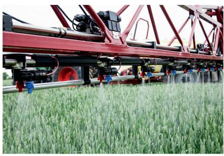
Ce système de buses pneumatiques Hardi permet au conducteur de basculer rapidement sur l'un ou l'autre modèle ou de les utiliser les deux en même temps. Photo: Hardi Auto Select
