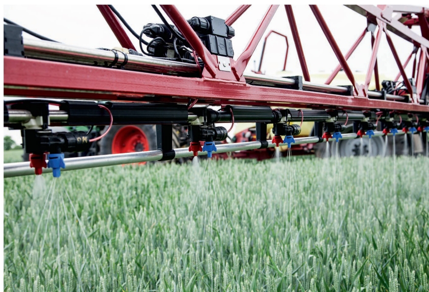
Ce système de buses pneumatiques Hardi permet au conducteur de basculer rapidement sur l'un ou l'autre modèle ou de les utiliser les deux en même temps. Photo : Hardi Auto Select
