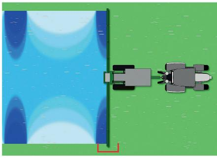
En stabilisant les mouvements de la rampe, Amazone vise principalement à éliminer les surdosages ou sous-dosages de surfaces partielles. Photo: Amazone SwingStop
