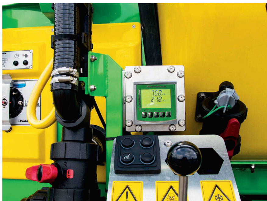
Le Fluid Indicator mesure le pH et la température de l'eau et indique à l'utilisateur les résultats sur l'écran. Photo : Dammann Fluid Indicator
