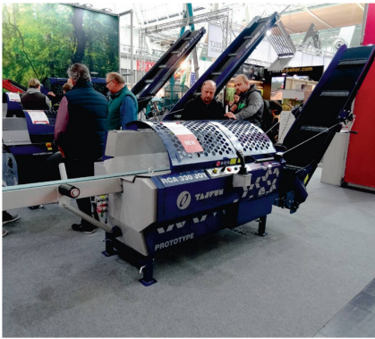
Scieur fendeur «RCA 330 Joy» de Tajfun, avec commande par monolevier.
