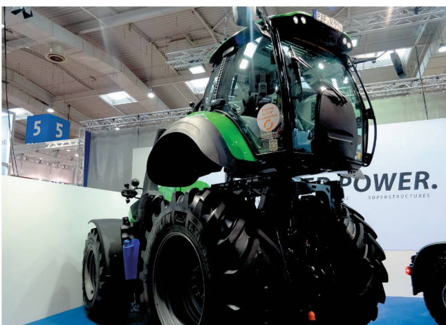
Cabine rotative et surélevée du Deutz-Fahr «TTV 9340 Agrottron».
