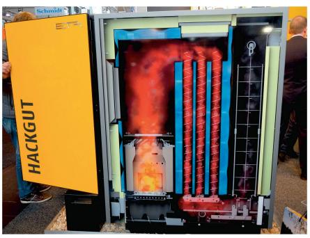
Chaudière de la série «Eta eHack» avec filtre électrostatique à poussières intégré (à droite).
