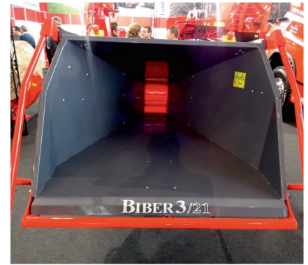
Sur le «Biber» de Eschlböck, les arceaux de guidage facilitent l'introduction des bois.
