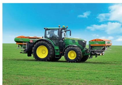
d'engrais en un seul passage. À la différence de l'épandage de mélanges d'engrais avec un seul distributeur, cette option permet de régler chaque outil de façon optimale, en fonction des propriétés respectives des produits, et de parvenir ainsi à une répartition transversale parfaite des fertilisants.
