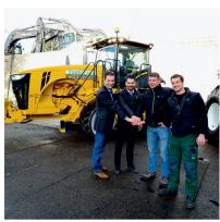
Ce tracteur avec GPS de près de 3 mètres de large, pour 16 tonnes de poids à vide, sera avant tout utilisé avec une sous-soleuse de 1,2 mètre de profondeur pour décompacter des sols très dégradés. Cet acquisition couronne une longue phase d'évolution de l'entreprise.
