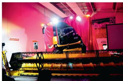
rales jusqu'à 18 % et, last, but not least, l'exécution « Hillside » permet à la machine de battre dans des montées atteignant 30 %. Cet engin se classe dans la catégorie des moissonneuses-batteuses de taille moyenne, mais est dotée d'une cabine Deluxe, comme une grande.
