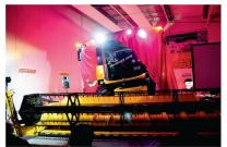
rales jusqu'à 18 % et, last, but not least, l'exécution « Hillside » permet à la machine de battre dans des montées atteignant 30 %. Cet engin se classe dans la catégorie des moissonneuses-batteuses de taille moyenne, mais est dotée d'une cabine Deluxe, comme une grande.
