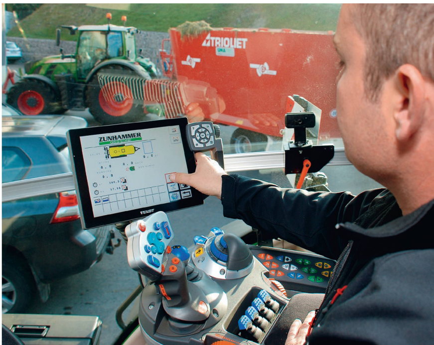
L'écran tactile et un outil de saisie qui permet d'agir du bout des doigts directement sur un ordinateur ou une machine. Photo : Heinz Röthlisberger
