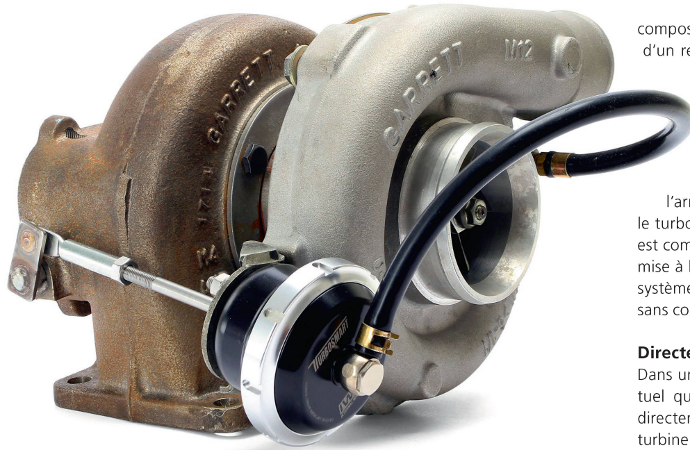
Le moment et la taille de l'ouverture de la soupape waste gate sont régulés par la soupape de dépression (à gauche), qui commande la pression de charge. Photo: ldd
