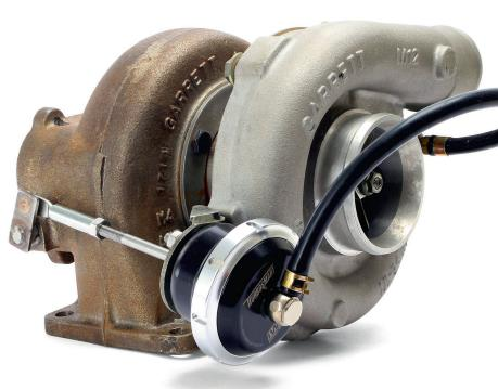
Le moment et la taille de l'ouverture de la soupape waste gate sont régulés par la soupape de dépression (à gauche), qui commande la pression de charge. Photo: Idd
