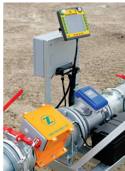
Les capteurs NIR sont onéreux. Ils peuvent toutefois permettre un épandage plus précis du lisier. Photo: Zunhammer
