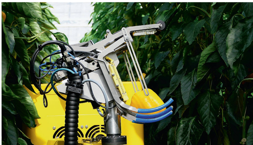
«Sweeper» reconnaît le poivron, détermine sa position, le saisit et coupe la tige. Photos : A. Bakker, sweeper-robot.eu
