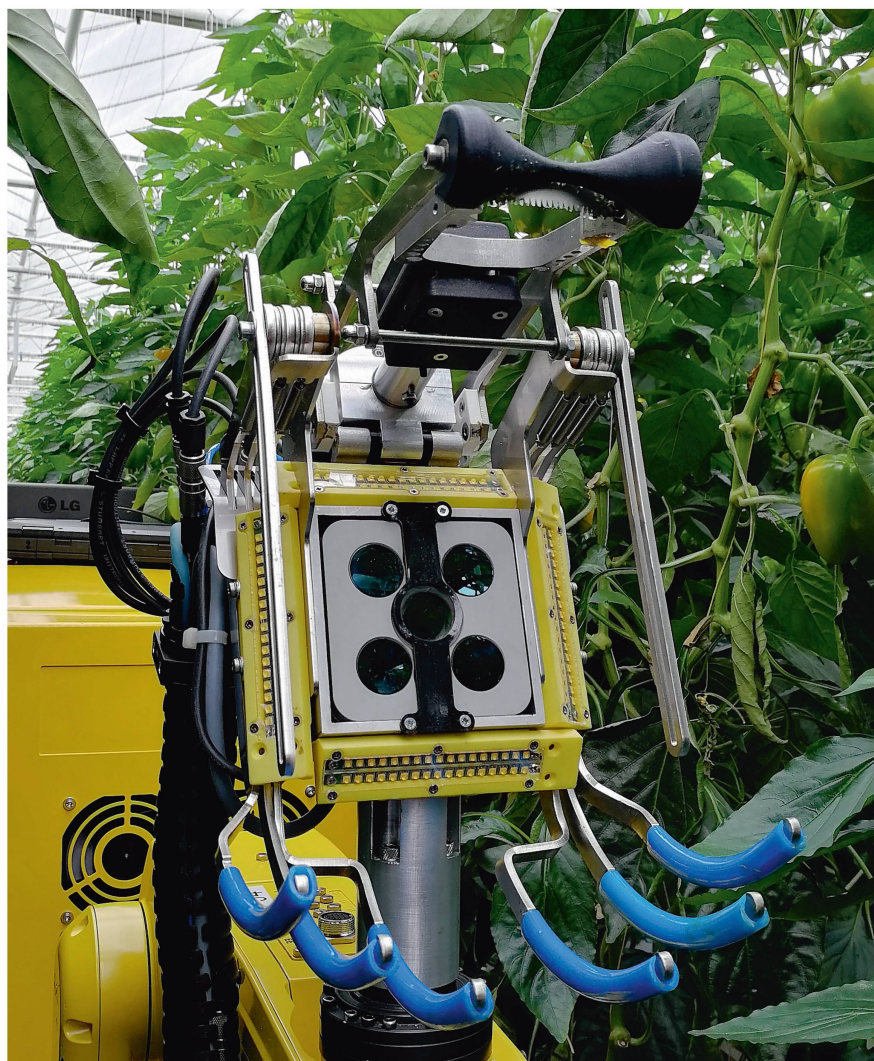
Cette caméra 3D sert à reconnaître et à déterminer la position exacte des poivrons mûrs.
