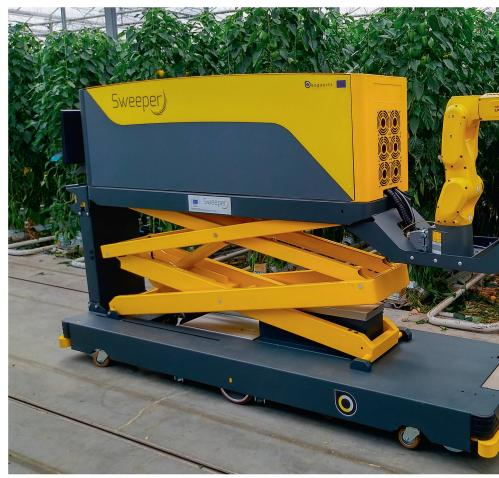
Le robot mobile en trois dimensions est installé sur une plate-forme mobile réglable en hauteur.
