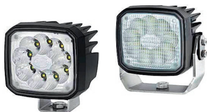
Les projecteurs LED ont une longue durée de vie. En cas de défaillance, c'est toutefois l'ensemble du module qui doit être changé. Le remplacement d'une seule diode n'est pas possible. Photo : Hella
