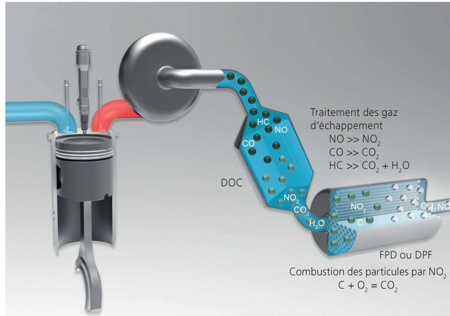
**Le catalyseur d'oxydation diesel (DOC) réduit le monoxyde de carbone (CO) et les hydrocarbures (HC), présents dans les gaz d'échappement, et soutient aussi le travail du filtre à particules diesel (FPD ou DPF).** Schéma: MTU
