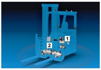
Le chariot élévateur mis au point par ZF est notamment doté d'une direction électromécanique «eSteer» (1) et d'une motorisation électrique individuelle des roues «eTrac» (2). Photos: ZF
