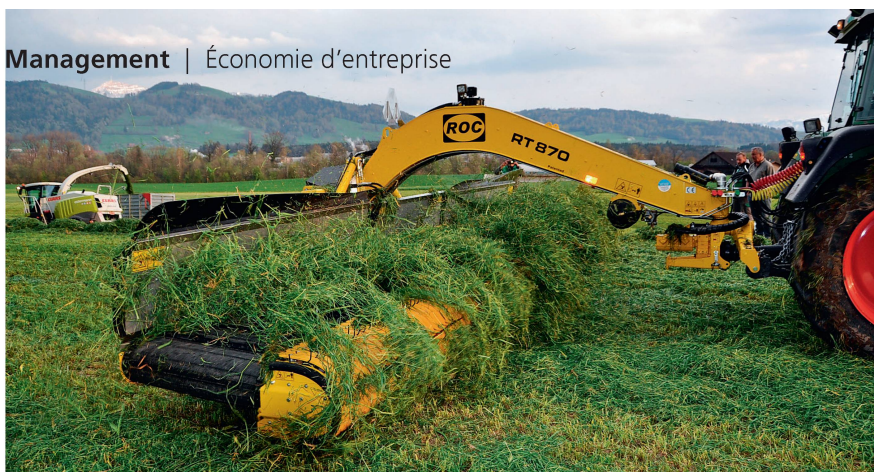
Par rapport aux andaineurs à rotateurs, les andaineurs à pick-up présentent de meilleures performances et qualité de fourrage, mais sont plus chers. Photo : Stefan Wyss
