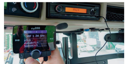
Le tuner « DAB+ » alimente l'autoradio existant par un câble branché sur « AUX-In ».
