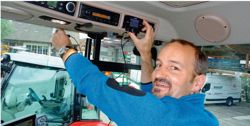
Beat Schmid installe un tuner « DAB+ » sur l'autoradio existant d'un tracteur.
