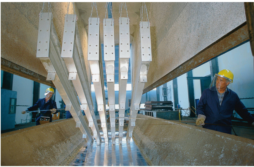
Cette photo présente des pièces d'acier à la sortie du bain de zinc. Photos : Idd
