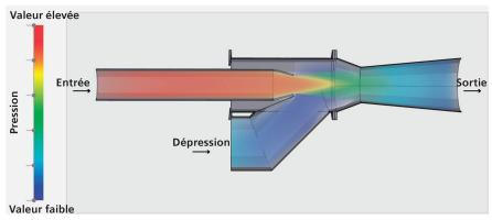
Système éjecteur de Samson selon le principe de Venturi. Le rétrécissement engendre une dépression qui, dans le cas précis, aspire le lisier. La pression diminue vers la partie centrale du dispositif, où elle atteint son minimum, exerçant un effet d'aspiration sur le liquide. Puis la pression remonte en allant vers la sortie. Schéma: Idd
