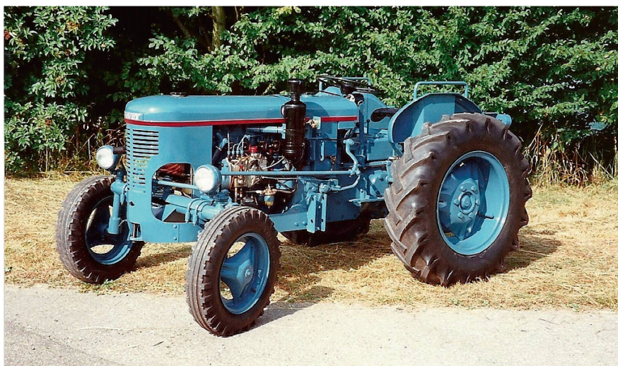
Les Vevey comptaient parmi les tracteurs suisses les plus évolués, avec leur trois-points hydraulique, leur prise de force normalisée, leur voie réglable à l'avant et à l'arrière de série.
