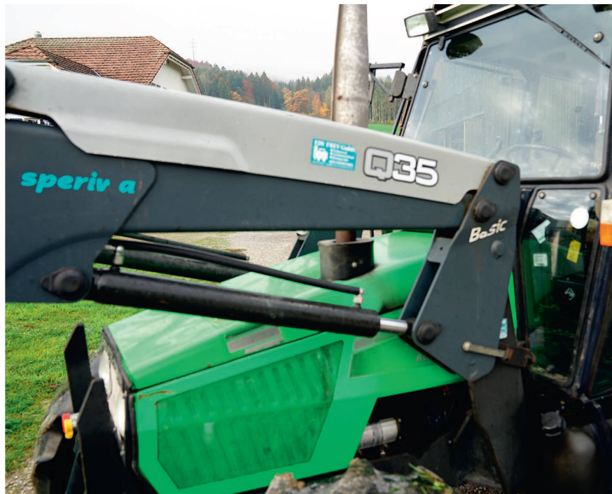
« On voit tout ce qui se passe à l'avant » : Raphael Elmiger explique les avantages d'un capot plongeant. Le chargeur frontal a été monté après coup.
