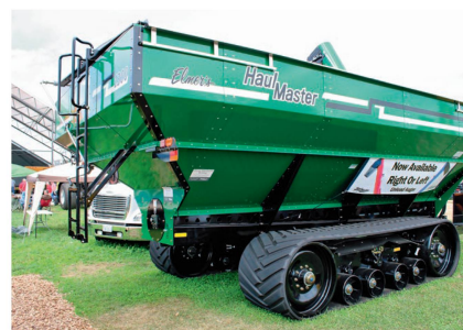
Même cette benne de transbordement est équipée de trains de chenilles.
