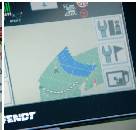
Le terminal Isobus du tracteur affiche les 12 tronçons gérés automatiquement (photo de gauche) ainsi que les zones déjà traitées par l'épandeur et celles qui ne le sont pas encore (photo de droite). Pour ce faire, les données du champ ont été saisies antérieurement.
