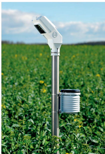
Le «Field Sensor» de Bosch est constitué d'une batterie de capteurs intégrés dans un support métallique en forme de pieu.
