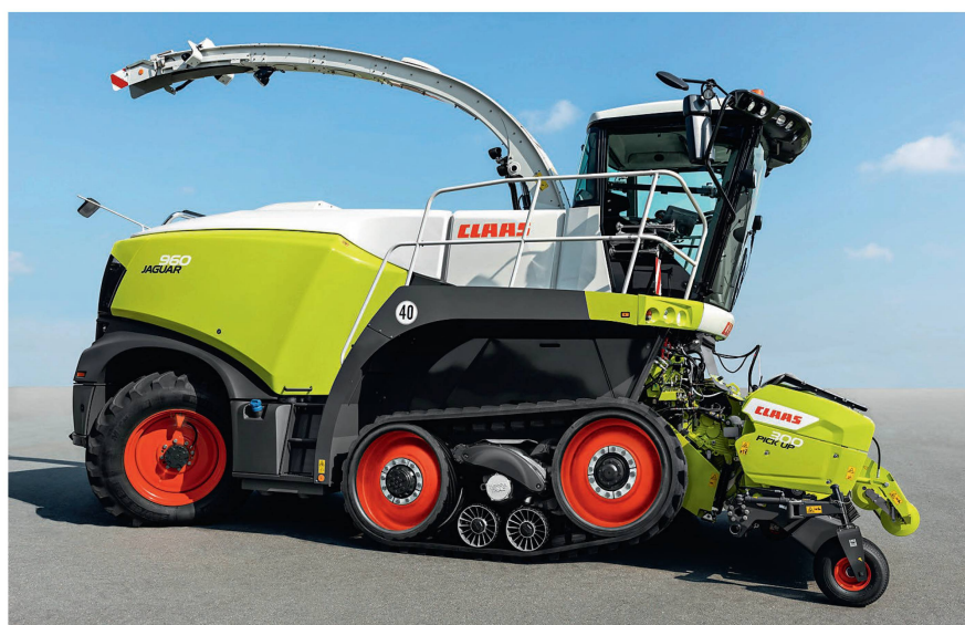
Claas a remporté une médaille d'or pour son train roulant à chenilles « Terra Trac », spécialement adapté aux ensileuses « Jaguar 960 » pour réduire le rippage dans les courbes.
