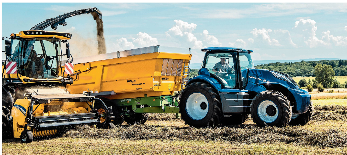
Dans un premier temps, la motorisation à base de méthane est testée quant à sa faisabilité sur les gros tracteurs. Photos : CNH
