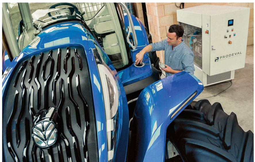
Un moteur au méthane nécessite un réservoir volumineux en raison de la densité d'énergie plus faible du méthane par rapport au diesel.
