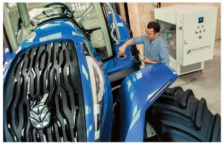
Un moteur au méthane nécessite un réservoir volumineux en raison de la densité d'énergie plus faible du méthane par rapport au diesel.
