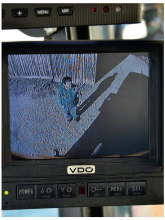
Les caméras de recul permettent de visualiser l'arrière du véhicule. La personne se trouvant derrière la machine apparaît clairement à l'écran de l'ordinateur monté dans la cabine. Photos: Ruedi Hunger
