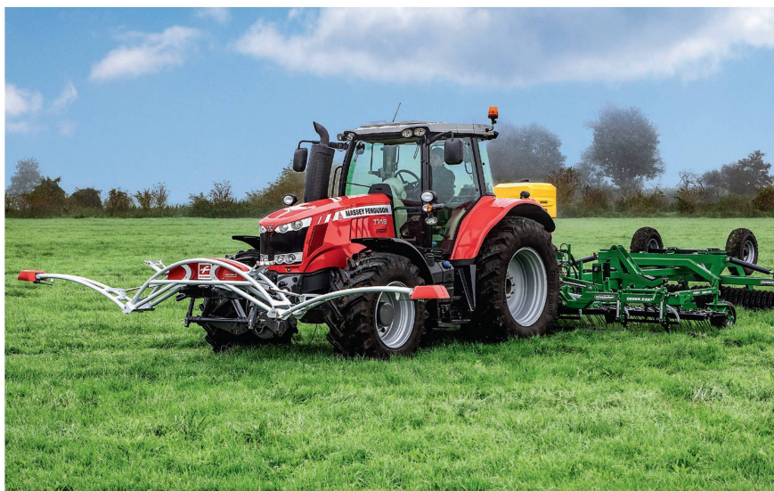
Les capteurs optiques sont utilisés pour la fertilisation, la protection des plantes et le sursemis des prairies. Photo : Fritzmeier/Isaria
