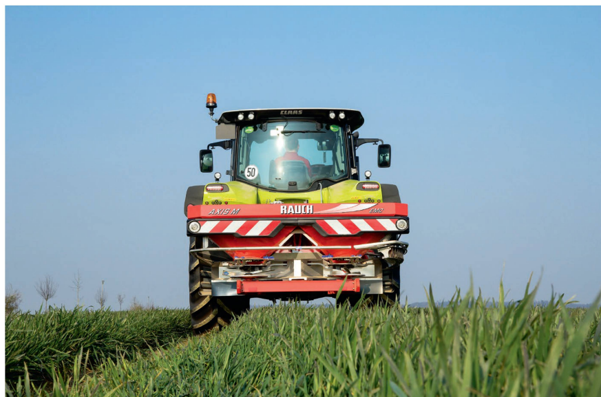
Les capteurs radar de Rauch et Amazone mesurent la quantité d'engrais éjectée. Photo : Rauch
