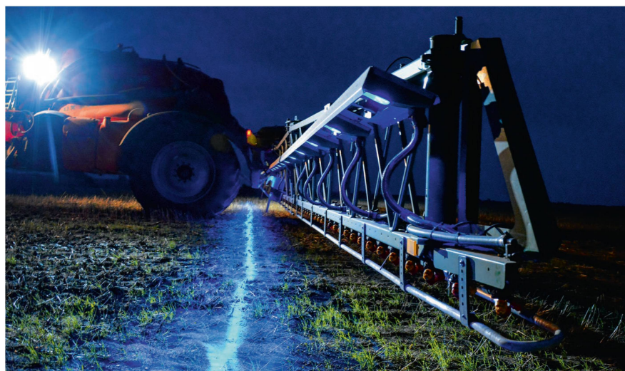
Grâce aux capteurs de fluorescence, l'application des produits phytosanitaires peut être limitée à certains végétaux. Photo: Amazone
