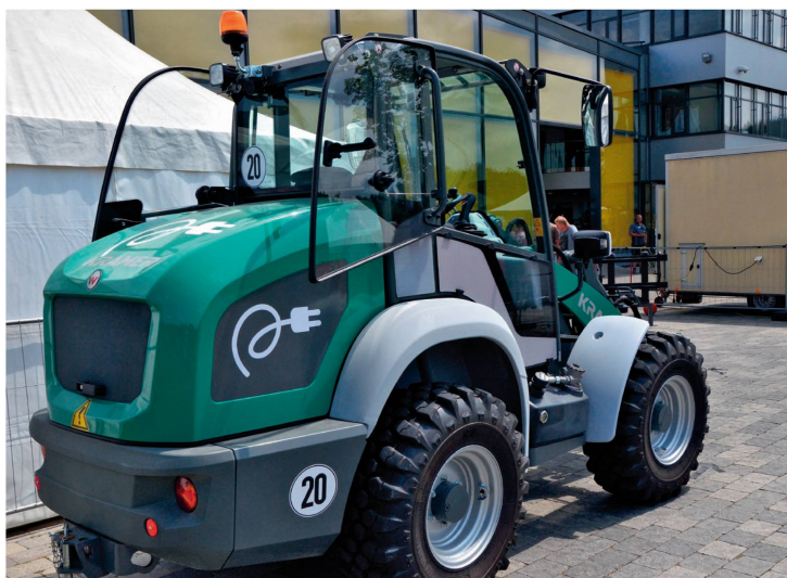
Souvent utilisés dans les étables et les bâtiments sensibles aux gaz d'échappement, les véhicules de levage sont prédestinés pour les moteurs électriques. Photo: Ruedi Hunger
