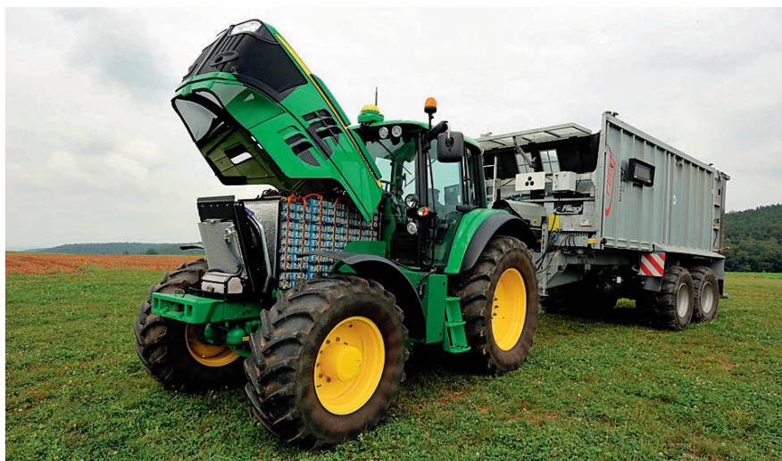
Des prototypes de tracteurs électriques à batteries, comme ce « JD Sesam », sont déjà en phase de tests. Photo : JD
