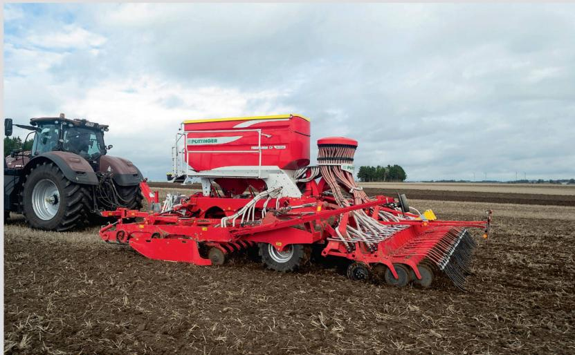
Sur ses machines combinées pour les semis directs sur mulch « Terrasem », Pöttinger propose désormais un dispositif de distribution d'engrais permettant la dépose, dans la terre et en profondeur, de micro et de macro fertilisants, tout cela durant le passage du semoir. « Cette apport de fertilisant génère des conditions de croissance optimale pour la culture, dès la phase de démarrage du semis et des jeunes plants », écrit Pöttinger dans un communiqué. Un avantage
