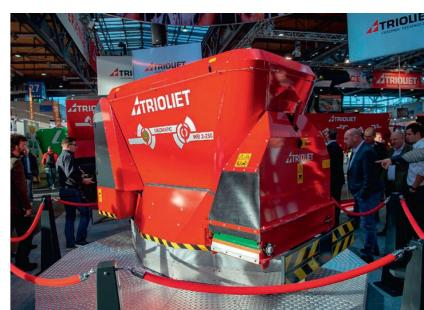
Trioliet ajoute à sa gamme de robots d'affouragement le « Triomatic WB 2 250 ». Ce modèle à deux vis est alimenté par batte-
