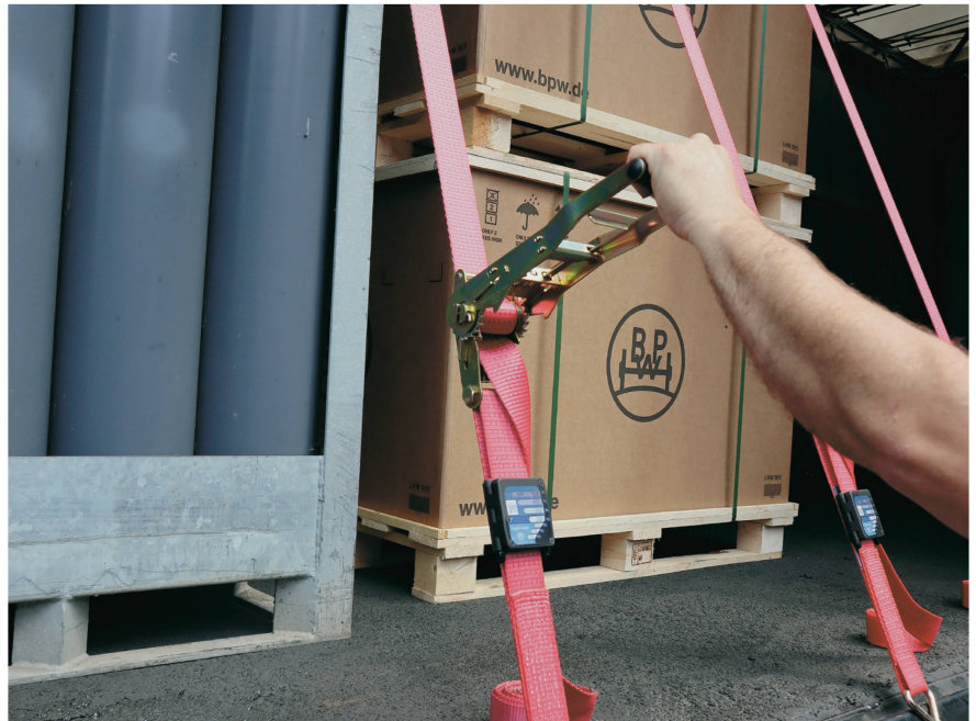
Le système «iGurt» contrôle et documente la tension des sangles. Les données récoltées peuvent être affichées sur un smartphone ou une tablette. Photo : BPW
