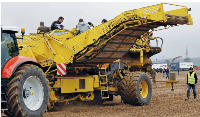
L'arracheuse « Keiler 2L » de Ropa est munie d'une trémie et d'un système de transbordement, le corps de trémie et le tapis de déchargement à triple articulation étant entraînés séparément.
