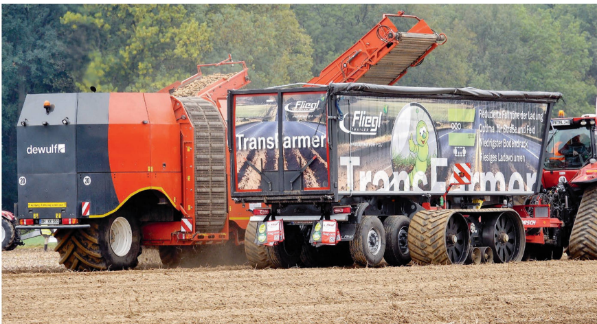
Le « Trailer Lift » de Horsch est un dolly à chenilles conçu pour supporter le poids de la benne de la semi-remorque « TransFarmer » de Fliegl. Photos: Ruedi Burkhalter
