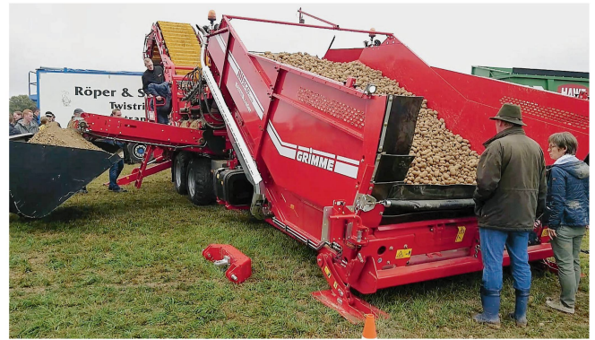
Les stations de chargement classiques telles que le « Clean Loader » de Grimme possèdent une grande unité de déterrage et permettent à quatre personnes de travailler autour du tapis d'inspection.
