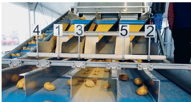
Le système de tri opto-électronique « Visar Sortop Potatoes » possède six sorties, pour lesquelles différents critères de qualité peuvent être définis librement sur un écran tactile.
