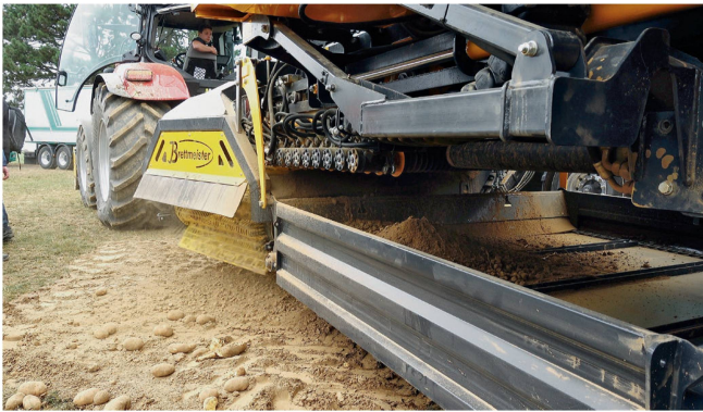
La remorque de transbordement « K3 » de Brettmeister recueille la terre détachée pendant le transbordement dans une trémie à fond mouvant pour la ramener au champ.
