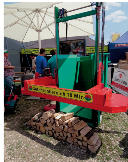
La nouvelle scie à bois de feux Stanggassinger pour bras de chargeur frontal.
