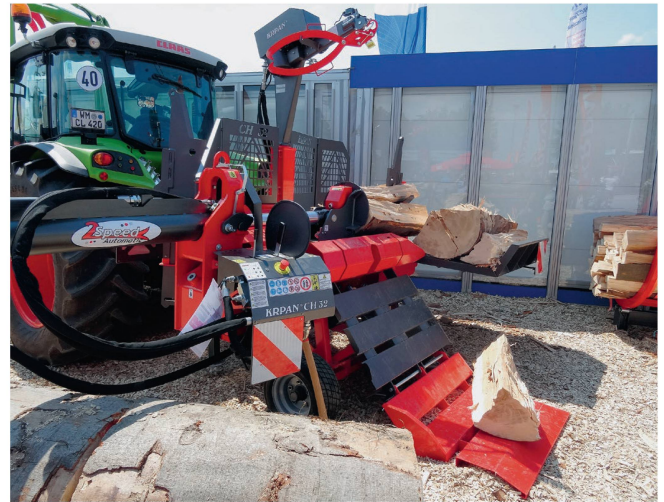
Les grandes fendeuses doivent être protégées par des grilles et des dispositifs de protection.
