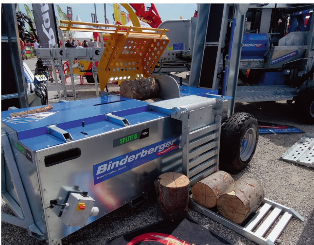
Binderberger a exposé un prototype de fendeuse entièrement carrossée pour minimiser le risque de blessures pour les opérateurs.
