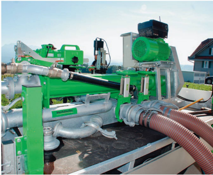
La pompe à lisier dispose de deux raccords de part et d'autre, l'un pour le lisier, l'autre pour l'eau.
