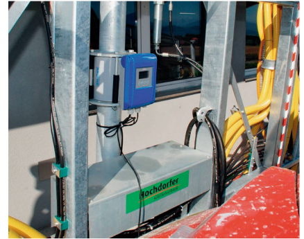
Un débitmètre est monté sur la pompe et l'autre sur la rampe d'épandage à tuyaux souples. La pompe s'arrête automatiquement dès que le « ProfiPilot » détecte une différence excessive entre les deux débits mesurés.
