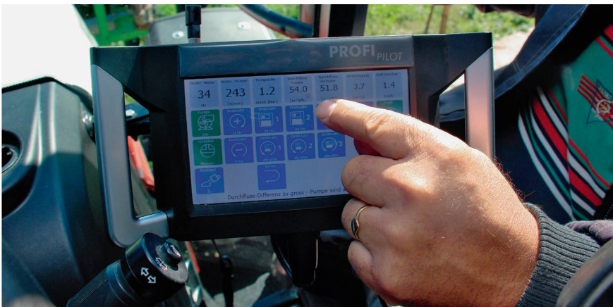
L'épandage du lisier est contrôlé depuis le tracteur grâce à la télécommande « ProfiPilot ». Celle-ci a été complétée par la détection du delta entre le débit d'entrée et de sortie pour les besoins de Thomas Estermann.
