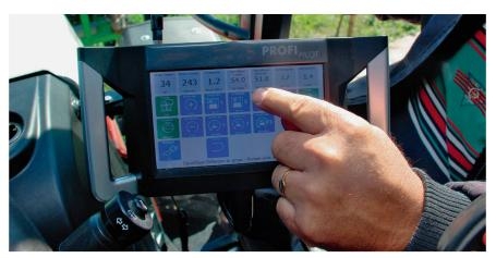
L'épandage du lisier est contrôlé depuis le tracteur grâce à la télécommande «ProfiPilot». Celle-ci a été complétée par la détection du delta entre le débit d'entrée et de sortie pour les besoins de Thomas Estermann.
