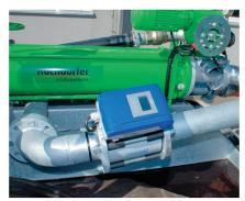
Un débitmètre est monté sur la pompe et l'autre sur la rampe d'épandage à tuyaux souples. La pompe s'arrête automatiquement dès que le «ProfiPilot» détecte une différence excessive entre les deux débits mesurés.
