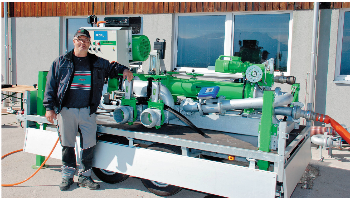
Thomas Estermann, de Hildisrieden (LU), pose fièrement à côté de la pompe à lisier spécialement développée selon ses idées. Il peut en piloter toutes les fonctions à distance avec la commande radio «Prof iPilot». Photos: Heinz Röthlisberger
