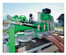
La pompe à lisier dispose de deux raccords de part et d'autre, l'un pour le lisier, l'autre pour l'eau.
