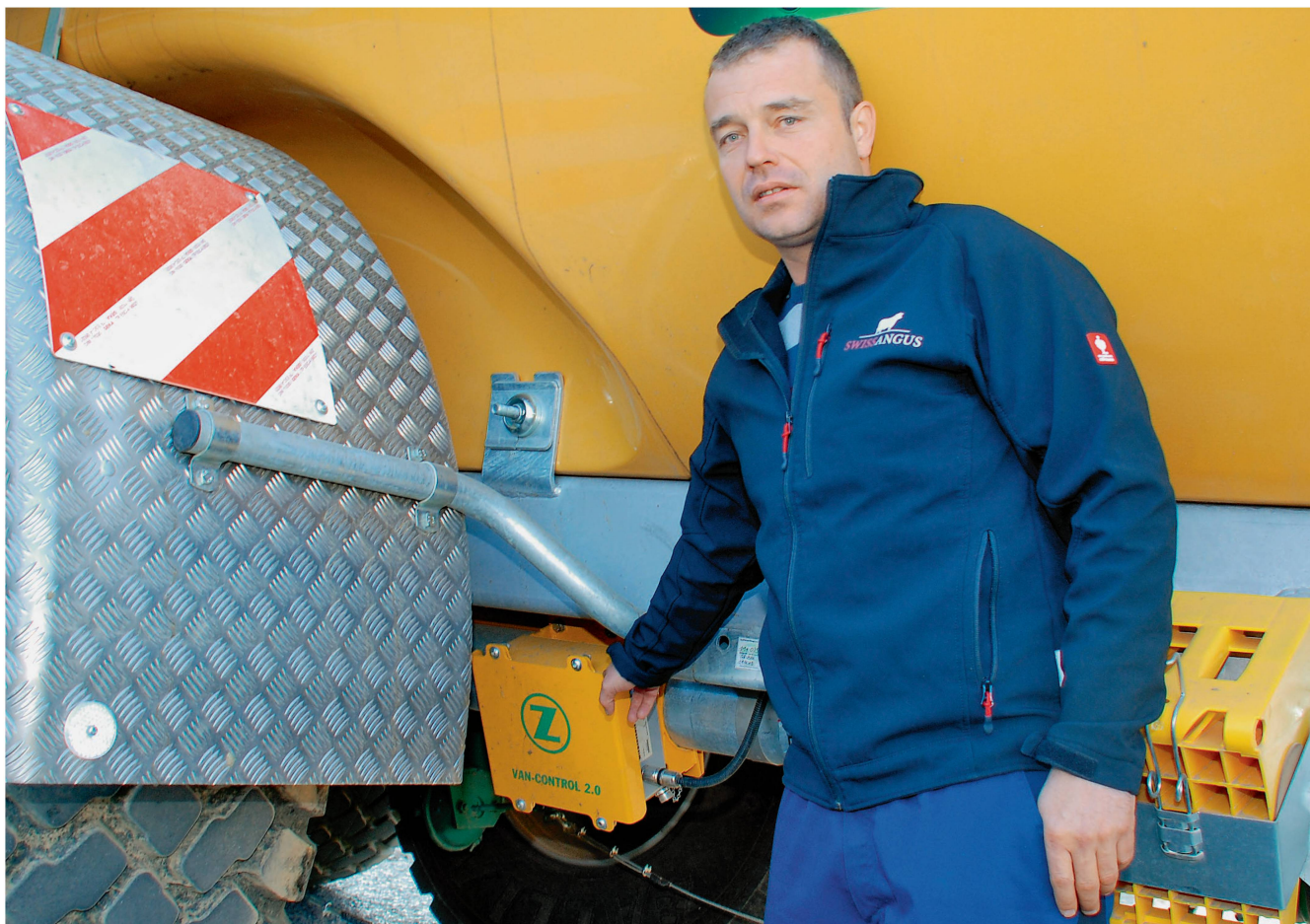
Pascal Grütznér, collaborateur de Fernand Andrey, montre le fonctionnement du « Van-Control 2.0 ». Le capteur NIR mesure la teneur en fertilisants du lisier seconde par seconde lors du ravitaillement de la citerne à lisier. Photos : Heinz Röthlisberger
