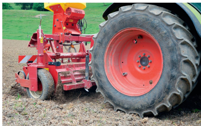
La roue placée sur le même plan vertical que le rotor garantit une profondeur de travail optimale et régulière.
