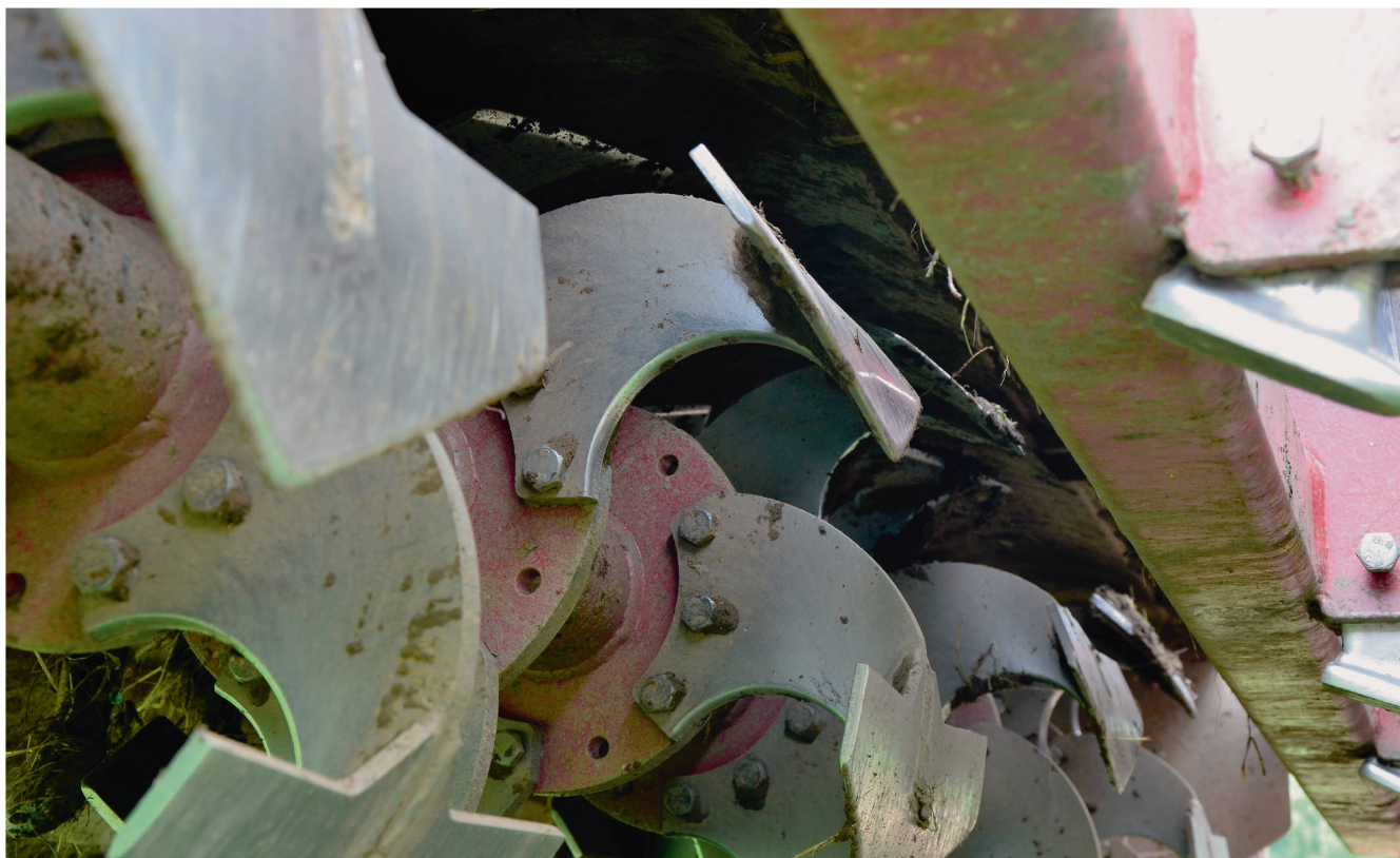
La clé du succès est la forme spéciale des « fers de rabot » répartis sur la périphérie du rotor. Photos: Ruedi Hunger
