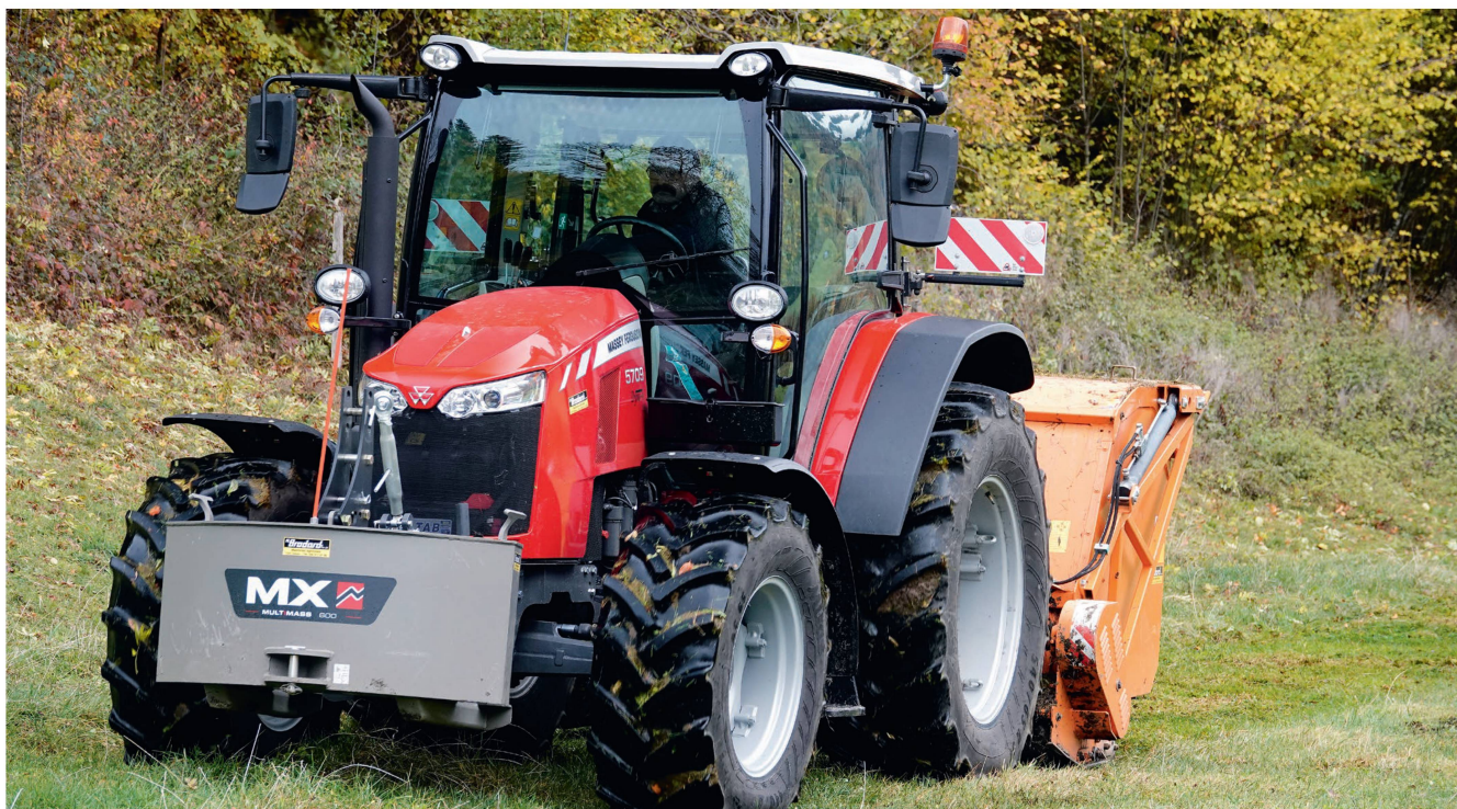
Avec sa force de relevage de 4300 kilos, le MF «5709 Dyna4 Global» maîtrise des outils très pesants. Photos: Ruedi Burkhalter
