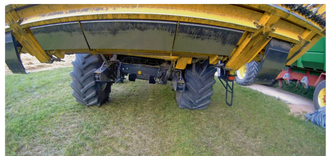
Dans la variante « Laterale », la machine est capable de compenser jusqu'à 18 % de pente avec l'assistance du « Smart Sieve ».
