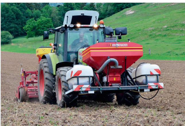
Le poids est mieux réparti si le réservoir de semences et les cuves d'accélérateur de décomposition sont placés à l'avant du tracteur.
