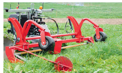
Deux roues à fixation pendulaire servent d'axe auxiliaire et, munies de leur vérin hydraulique, de support de relevage pour la barre de coupe.
