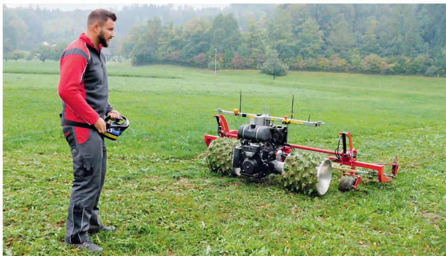
Déplacement partiellement autonome: un opérateur surveille le Rapid « Cosmos » à l'œuvre sur une prairie. Comme l'engin ne dispose pas de capteurs d'arrêt, il ne peut pas travailler de façon totalement indépendante. Photos: Roman Engeler
