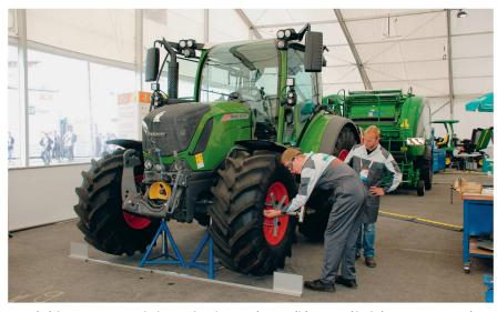
Lors de l'épreuve « transmissions mécaniques », les candidats ont dû régler correctement la voie et la butée de direction d'un tracteur.
