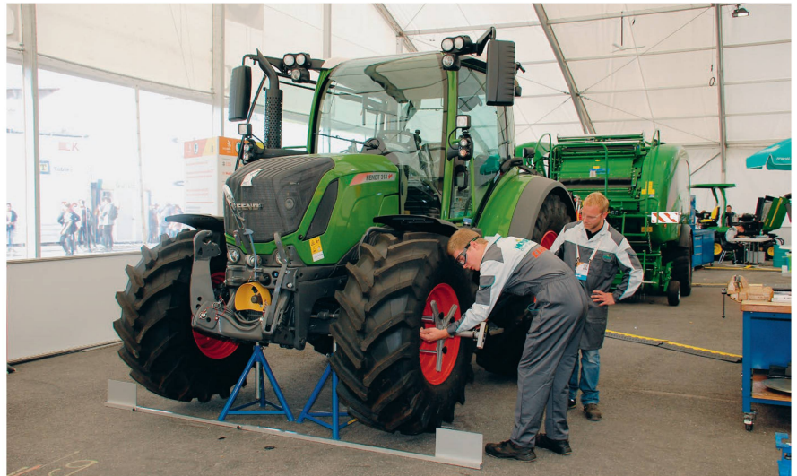
Lors de l'épreuve « transmissions mécaniques », les candidats ont dû régler correctement la voie et la butée de direction d'un tracteur.
