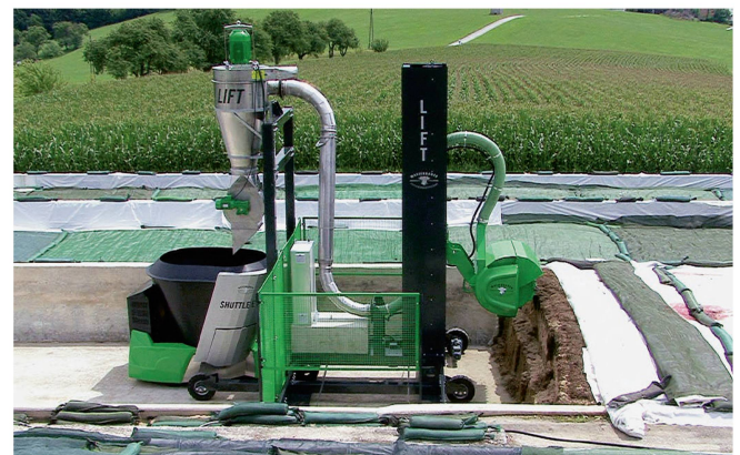
Wasserbauer a mis au point une désileuse automatique pour silos tranchés pour son robot d'affouragement. Photo : Wasserbauer
