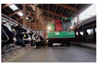
La mélangeuse-distributrice automotrice Strautmann «Veri-Q» doit bientôt être dotée d'un guidage autonome. Photo: Strautmann
