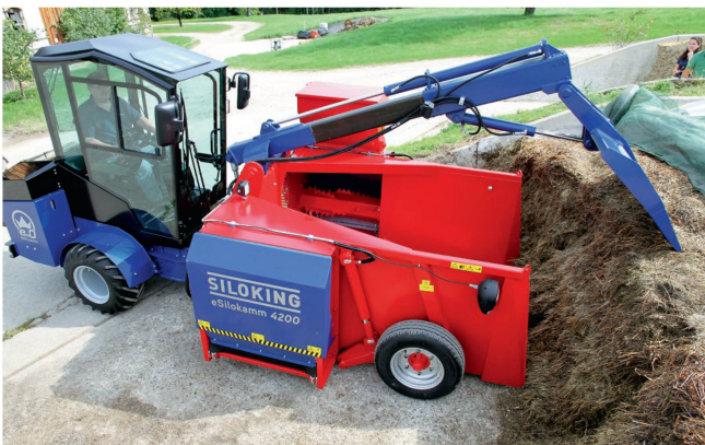
Siloking lance cette désileuse-distributrice automotrice « Silokamm » à entraînement électrique. Photo : Siloking
