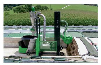
Wasserbauer a mis au point une désileuse automatique pour silos tranchés pour son robot d'affouragement. Photo: Wasserbaue
