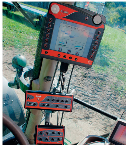
La machine est pilotée par le terminal Isobus «CCI 200» (en haut) ainsi que les boîtiers «CH10» (au milieu) et «Isoclick» (en bas).
