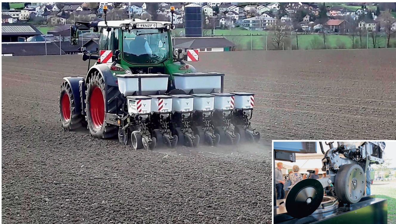
Prototype d'un semoir monograine de Precision Planting en train de planter des betteraves sucrières. Photos : Nils Zehner et Roman Engeler
