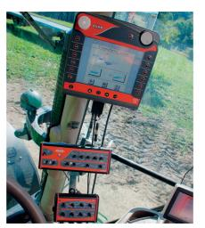
La machine est pilotée par le terminal Isobus «CCI 200» (en haut) ainsi que les boîtiers «CH10» (au milieu) et «Isoclick» (en bas).
