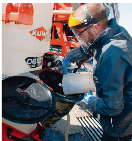
L'incorporeur «Optifiller» breveté de 42 litres est escamotable. Sa large ouverture facilite les opérations d'incorporation.
