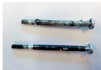
La vis de fixation du carburateur de la tronçonneuse « Hurricane » s'est rompue lors de l'essai.
