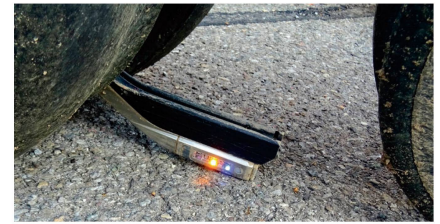
Les capteurs mesurent l'humidité, la température et la teneur en éléments nutritifs du sol pendant le semis.
