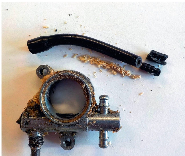
Cette pompe à huile avec conduite de lubrification bouchée est défectueuse.
