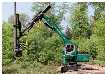
La récolteuse à chenilles « T50 », développée conjointement par Sennebogen et Impex, peut prélever des arbres entiers debout.
