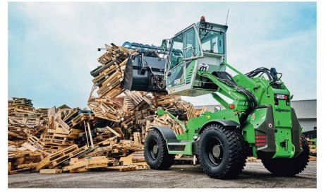
Le chariot télescopique «355» avec sa cabine à élévation assure au conducteur une excellente vision panoramique. Photos: Sennebogen
