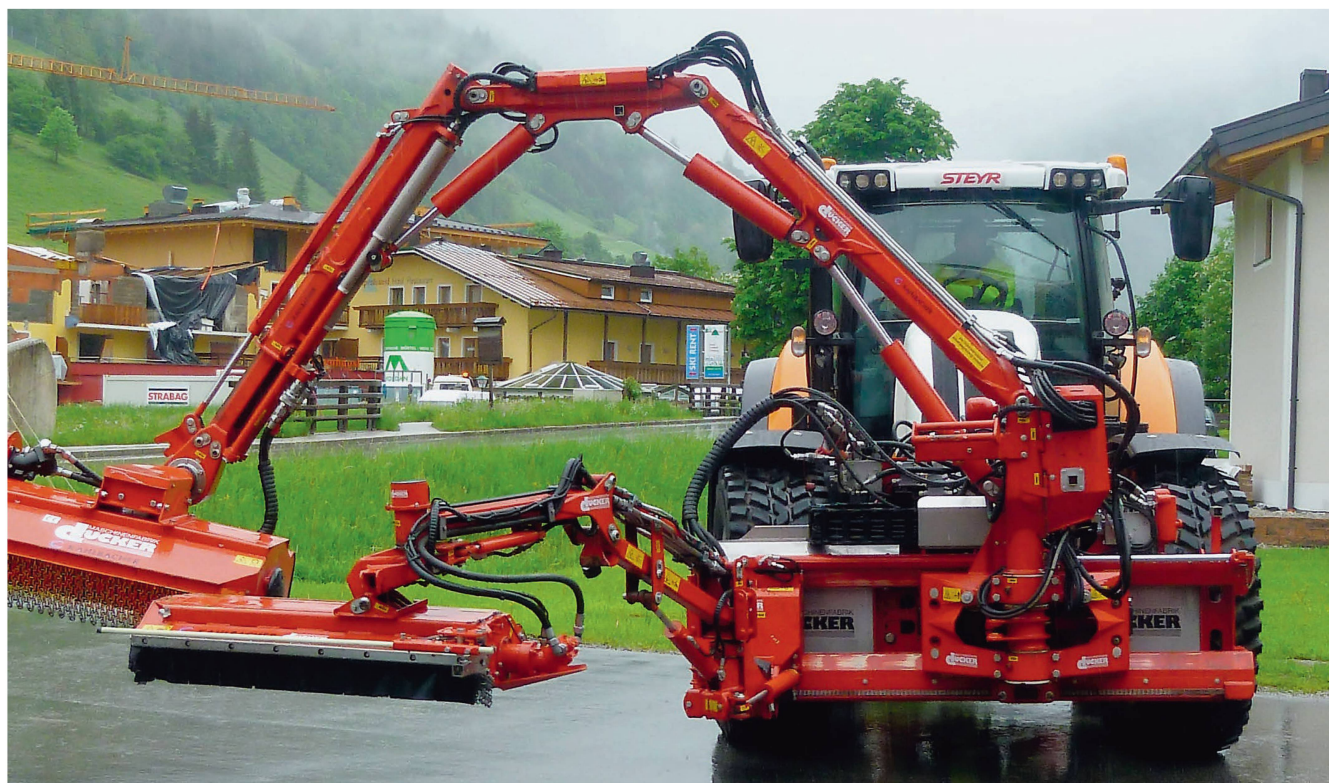
L'essieu avant subit des contraintes considérables dues à l'important porte-à-faux latéral et au poids élevé qu'il supporte. Photos : Ruedi Hunger, Kotschenreuther et Lindner
