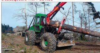
Les débusqueurs « NF » à 4 roues sont équipés de moteurs diesel lveco de 110, 129 ou 151 kW. L'entraînement hydrostatique passe par une boîte de transfert à deux vitesses. Les bras articulés sont équipés d'essieux rigides planétaires NAF avec différentiel verrouillable à 100 %. Enfin, les tracteurs sont dotés d'une cabine de sécurité ROPS/FOPS/OPS avec siège pivotant et confortable pour le conducteur.
