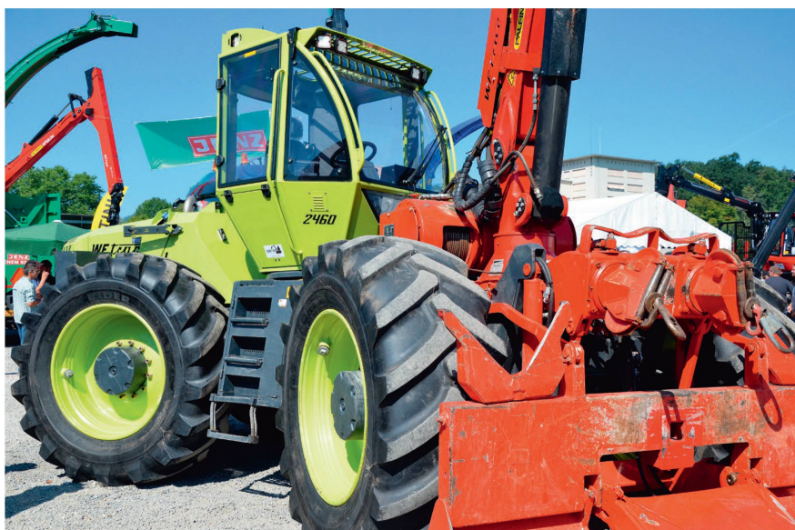
Le véhicule spécial désigné par le terme anglais «skidder» est presque incontournable dans une entreprise forestière. Photos : Ruedi Hunger
