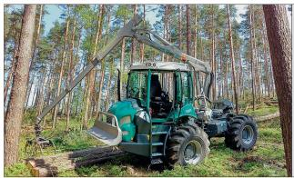
Pfanzelt pourvoit ses modèles à 4 roues de moteurs Deutz de 133 kW ou 174 kW. Ces 6 cylindres répondent aux normes antipollution usuelles avec un catalyseur SCR.
