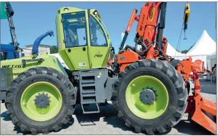
La version 4×4 du « WF Trac » se caractérise par une mise en œuvre systématique de principes efficaces pour un véhicule forestier. Certifiée KWF, elle peut être équipée d'une multitude d'équipements. Le montage d'une abatteuse et d'un treuil de 10 tonnes disposant au maximum de 150 m de câble transforme le « WF Trac » en récolteuse polyvalente.
