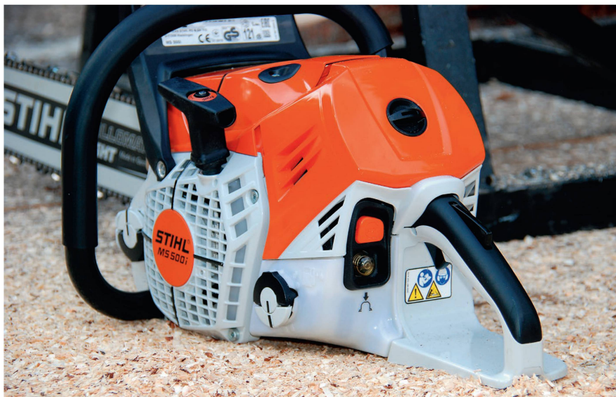
Le bouton orange pour arrêter la « MS 500i » et celui de la pompe à carburant, juste en dessous, constituent toute l'« instrumentation » de la « MS 500i ». Photos : Heinz Röthlisberger et Idd
