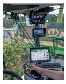
Grâce aux images 3D, l'ensileuse est capable de remplir automatiquement n'importe quel véhicule placé à ses côtés.
