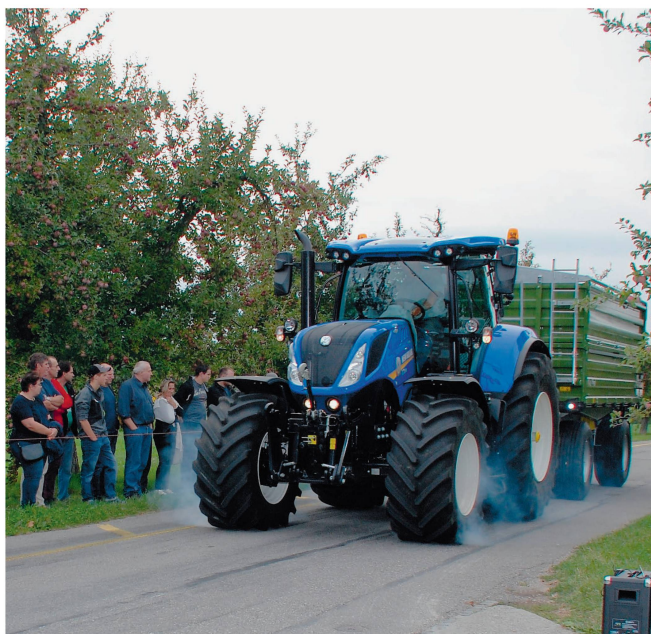
Freinage d'urgence avec le système hydraulique à double circuit «H2L» de Paul Forrer. Photo: Heinz Röthlisberger
