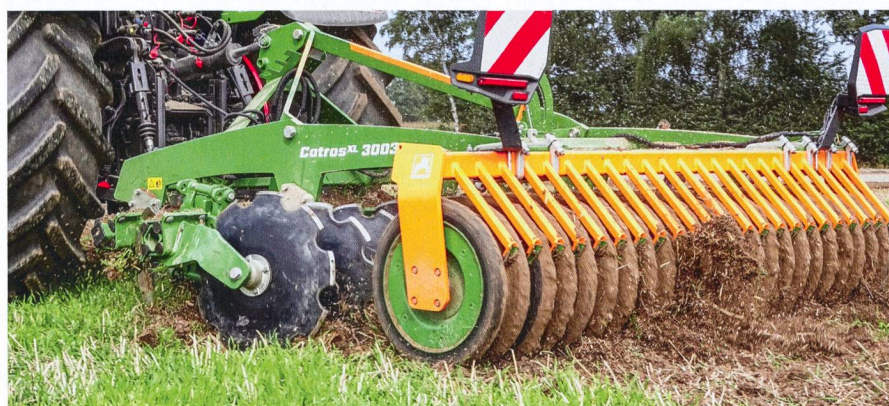
Amazone nomme sa nouvelle herse à dents «Catros XL». Il l'équipe de disques de 610 mm de diamètre avec des créneaux grossiers ou fins. Photos: Roman Engeler
