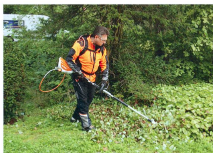
Le nouveau « KMA 130 R » est doté d'un accumulateur lithium-ion de 36 V.
