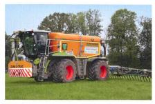
Concentré de puissance d'épandage, le «Zuni-X-Trac» est une tonne à lisier automotrice dérivée du «Xerion» de Claas.
