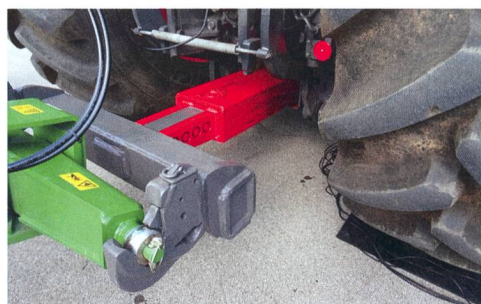
« VarioPull » : un vérin à verrouillage permet de déplacer le point de fixation de l'attelage ou des bras inférieurs du relevage jusqu'à 800 mm en direction de l'essieu avant.
