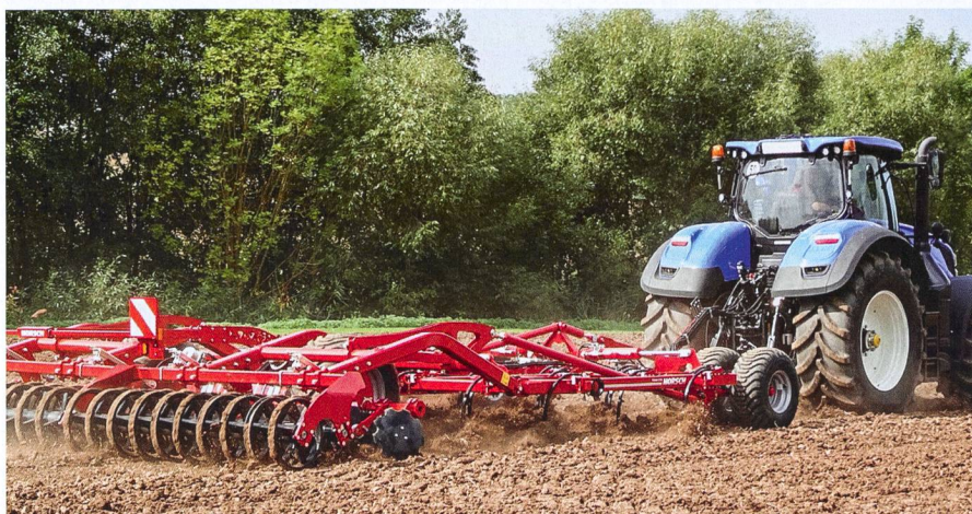
Le déchaumeur « Cruiser 5 XL » est équipé de nouvelles dents souples qui offrent plus de passage pour le matériel organique. Photos : Roman Engeler et Idd
