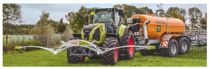
La modulation intraparcellaire de l'épandage d'engrais de ferme liquide est désormais possible en combinant des capteurs de nutriments et de biomasse dans une tonne à lisier.
