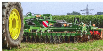
«Ceus» combine un déchaumeur à disques pour les zones plates avec un cultivateur à dents pour un travail jusqu'à 30 cm de profondeur.
