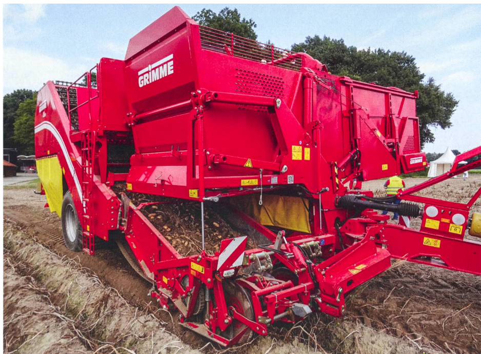
L'arracheuse de pommes de terre à deux rangs «EVO 290», ici un prototype, fera son apparition sur le marché dotée d'un design repensé et d'une trémie de 9 tonnes. Photos : R. Engeler
