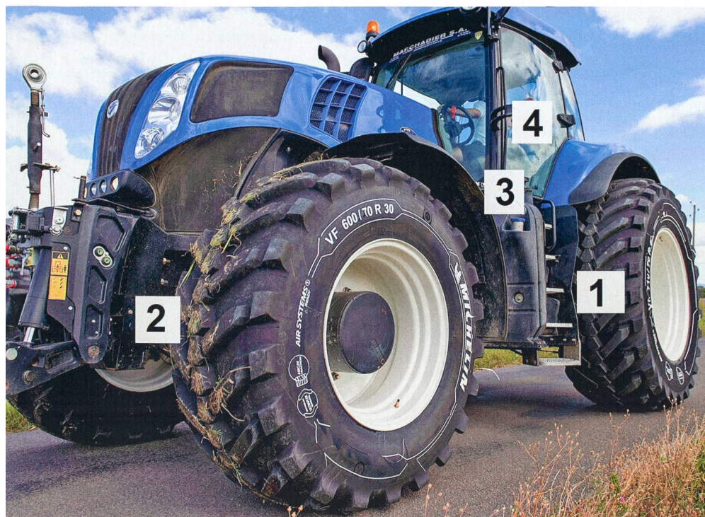
Les pneus (1) ainsi que les suspensions de l'essieu avant (2), de la cabine (3) et du siège (4) sont combinés en un système de suspension global d'un tracteur moderne. Photo: CNH
