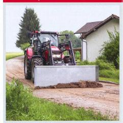
Les lames avec une arête en polyuréthane ménagent la surface de la chaussée. L'adaptation de la lame au profil de la chaussée est toute relative. Il est possible de nettoyer de grandes quantités de terre tassée, mais si le profil de la route est bombé, il est difficile de bien tout nettoyer proprement.
