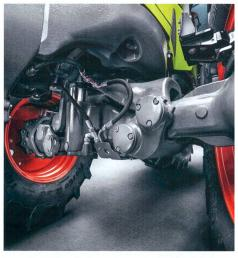
La suspension de l'essieu avant améliore le confort de conduite, mais le tracteur a tendance à tanguer lors du freinage et au démarrage, Photo: Claas
