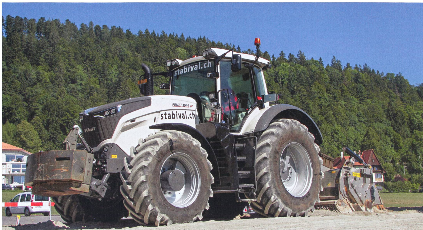
Le nombre d'échelons de l'escalier d'accès laisse deviner la taille du « 1046 Vario ». Le concasseur travaille le mélange à base de ciment jusqu'à une trentaine de centimètres de profondeur. Photos: Ruedi Burkhalter
