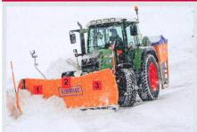
Ce chasse-neige est composé de plusieurs panneaux (1 – 3) escamotables vers le haut ou vers l'arrière en cas de collision. Chaque panneau est muni de sa propre bande racleuse au contact avec la chaussée. L'orientation du déblayage, à droite ou à gauche, est réglable en continu.
