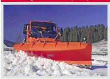
Les lames de déneigement monocorps en plastique conviennent particulièrement pour le service hivernal à faible altitude, où la neige à évacuer est souvent présente sous forme fondue ou mouillée. La lame autostable est intégrée dans un cadre en acier, à la fois stable et élastique, qui amortit les vibrations. Elle est protégée par un système de clapets montés sur ressorts précontraints. La position flottante intégrée autorise des vitesses de déneigement allant jusqu'à 40 km/h.
