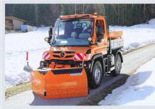
Les étraves transformables Vario possèdent deux lames pivotantes, orientables indépendamment l'une de l'autre à l'aide de deux vérins selon les conditions d'utilisation. Les configurations suivantes sont possibles : lame biaise, gauche ou droite, étrave ou étrave inversée (pour rassembler la neige)
