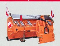
Les chasse-neige sont exposés au risque latent de heurt avec des obstacles. Compte tenu des vitesses pratiquées, à ne pas sous-estimer, certains composants risquent d'être exposés à des contraintes élevées. Les constructeurs protègent leurs chasse-neige par des systèmes à ressort travaillant en tension ou en compression, par des tampons ou par d'autres éléments élastiques en caoutchouc. Après actionnement d'une sécurité antisurcharge, le chasse-neige reprend sa position de travail.
