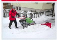
Les chasse-neige les plus simples possèdent une lame à neige en acier à positions de déblayage latérale gauche, dans l'axe et latérale droite. La bande racleuse au contact avec la surface à déneiger peut être réalisée en acier, en caoutchouc ou en plastique. Ces chasse-neige simples sont généralement dépourvus de protection anticollision (sauf év. des boulons de cisaillement), mais, compte tenu de leur faible vitesse, les risques de dégâts sont faibles.
