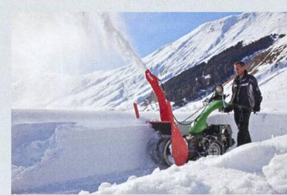
Ces machines sont conçues pour fonctionner en deux étapes. La première étape est accomplie par la fraise placée horizontalement et transversalement par rapport au sens de déplacement. Elle fraise la neige et la conduit à la deuxième étape. Celle-ci est constituée de la turbine qui reprend la neige, l'accélère et la projette au travers de la goulotte d'éjection.
