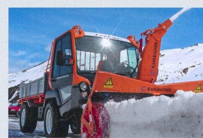
Les transporteurs assurent au conducteur une bonne vue d'ensemble sur l'appareil avant. La direction à quatre roues et la transmission continue offrent une bonne mobilité au véhicule. Les fraises, les souffleuses, les fraises-souffleuses et les brosses à neige peuvent être utilisées. L'entraînement se fait au moyen de la prise de force.
