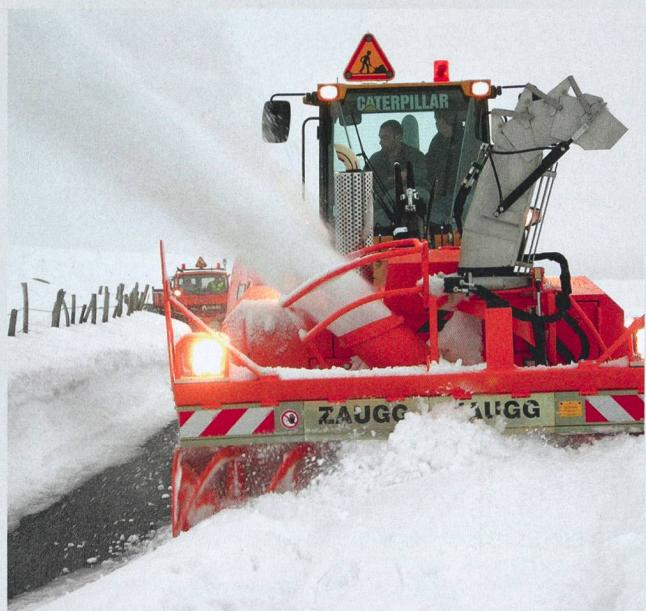
Les véhicules autopropulsés avec des puissances moteur allant jusqu'à 500 kW peuvent déblayer de 4000 à 6000 t de neige à l'heure, selon les conditions d'utilisation. Ces machines sont équipées d'un moteur qui entraîne les roues et le dispositif de déblaiement. L'entraînement des roues est hydrostatique, le dispositif de déneigement étant entraîné de la même manière ou mécaniquement.
