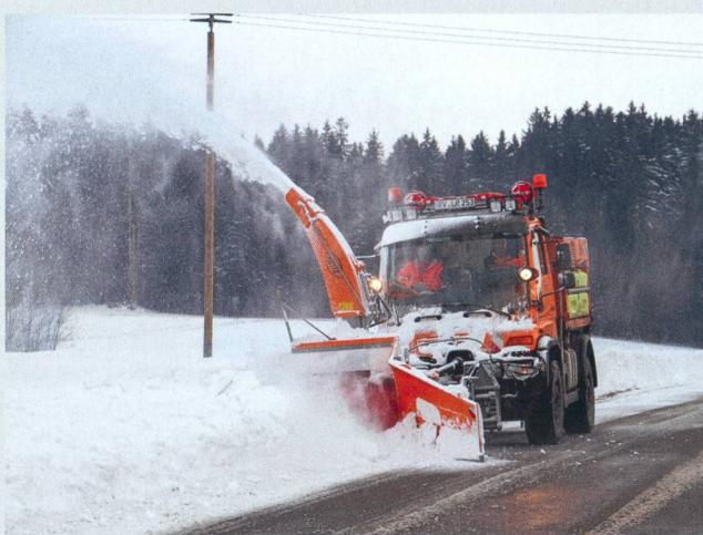
Fraise latérale à simple étage pour le débâlelement latéral de la neige accumulée par la lame. La lame d'alimentation supplémentaire pousse les résidus de neige jusqu'à la fraise. Un dispositif de chargement est disponible pour le transfert de neige sur camions. En outre, un système de guidage du canal d'éjection permet d'optimiser le chargement de la neige.
