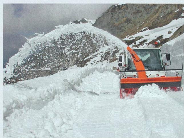
Ces unités à deux étages sont utilisées pour le déneigement universel. La neige fraîchement tombée et la neige comprimée peuvent être dégagées. L'entraînement se fait par prise de force. En plus des goulottes d'éjection simples (photo), des canaux de chargement spéciaux sont également utilisés. Les bandes d'usure sont composées d'acier résistant.
