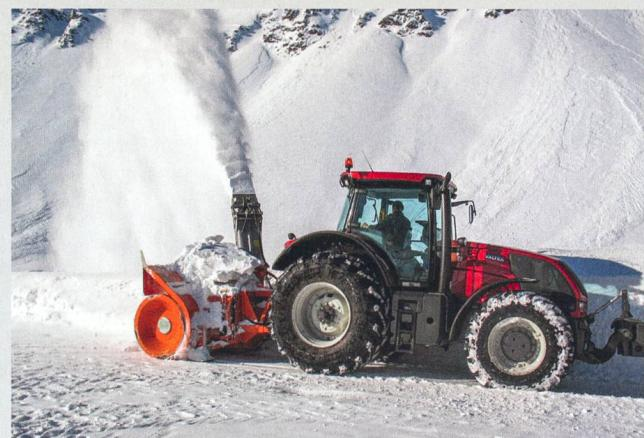
L'espace de fixation avant est bien adapté pour l'installation de souffleuses à neige. Cependant, la charge admissible de l'essieu avant doit être considérée. En ce qui concerne le montage frontal, les prescriptions en matière de circulation routière selon les articles 64, al. 3, de l'OCR et 28a de l'OETV sont à respecter. Le tracteur doit disposer d'une transmission permettant des vitesses de déplacement lentes.
