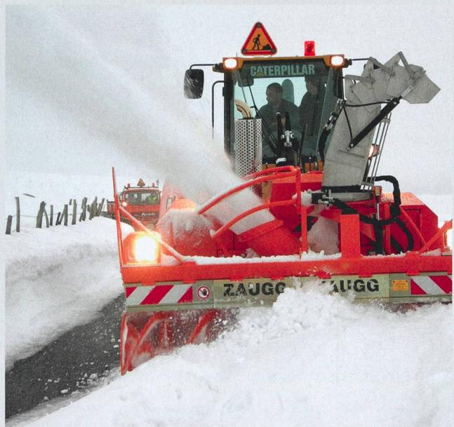
Pour les chargeurs sur pneus, il existe des souffleuses à neige autonomes qui peuvent s'atteler au système d'attelage rapide. Celui-ci se verrouille en quelques manipulations et par une personne seule. Ces unités sont également construites selon le système à deux étages avec fraise et turbine centrifuge. La puissance du moteur est de 80 kW (Zaugg).
