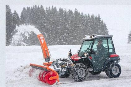
Les faucheuses à deux essieux sont équipées d'appareils de déneigement des catégories petites à moyennes. La technologie Stepless, les quatre roues motrices et la direction sur les quatre roues rendent le véhicule très mobile. La fixation se fait presque exclusivement au 3-points avant. L'entraînement est assuré par prise de force.
