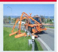
Intervention délicate à la fois pour le chauffeur et le machiniste, accompagnée d'une forte sollicitation du véhicule porteur. Une telle combinaison triple utilisant les différents espaces de montage n'est possible qu'avec un véhicule spécial tel que cet Unimog.
