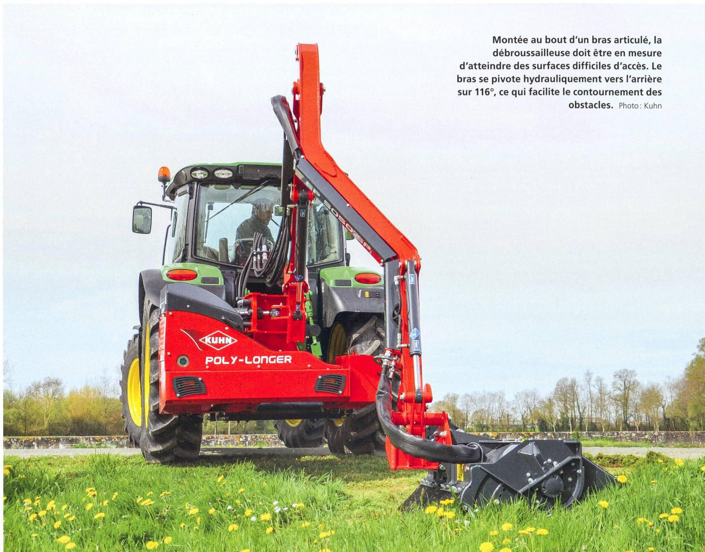
Montée au bout d'un bras articulé, la débroussailleuse doit être en mesure d'atteindre des surfaces difficiles d'accès. Le bras se pivote hydrauliquement vers l'arrière sur 116°, ce qui facilite le contournement des obstacles. Photo: Kuhn
