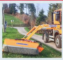
Groupe de broyage à entraînement hydraulique supporté par un bras articulé à montage frontal fixé sur un cadre permettant le déplacement latéral. Le véhicule porteur est un véhicule spécial (ici un transporteur équipé d'un semi-hydrostat). La plage de visibilité du conducteur dépend de la position du siège.
