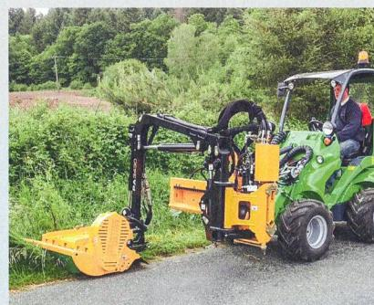
Les situations ne sont pas rares où un véhicule porteur étroit, avec un bras articulé adapté, s'avère plus performant qu'un véhicule de grande taille. Dans bien des cas, un véhicule étroit peut circuler en dehors de la chaussée, donc sans gêner la circulation. Le conducteur bénéficie en outre d'une meilleure visibilité.
