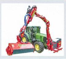
Le montage frontal, qui a pour inconvénient de solliciter fortement l'essieu avant du tracteur, présente l'avantage d'assurer au conducteur une excellente visibilité. La photo représente la variante lourde d'un bras articulé en trois parties avec balancier télescopique. Pour mieux répartir le poids, certains fabricants proposent une construction distribuée où le réservoir hydraulique est placé à côté du système hydraulique arrière.
