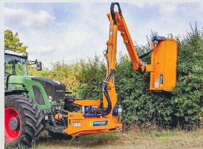
Alternativement à l'alimentation hydraulique à partir d'un réservoir embarqué, il est possible d'utiliser l'hydraulique de puissance du véhicule porteur. Les faucheuses de talus modernes sont souvent pilotées par un système monolevier ou un joystick, à même de garantir un confort d'utilisation élevé.
