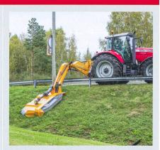
S'il s'agit de faucher des talus à proximité du tracteur, il est préférable d'utiliser des bras articulés courts. Avec ce type de construction, l'entraînement par courroie reste possible. La photo représente une débroussailleuse à axe horizontal.
