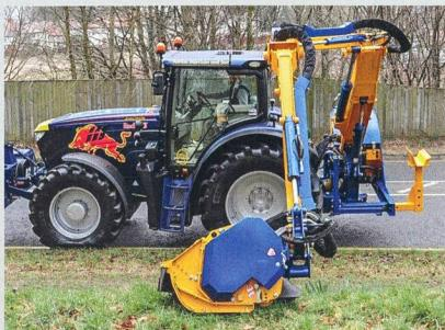
Les organes hydrauliques sont normalement alimentés en huile à partir du réservoir embarqué. On a ainsi la garantie d'un système hydraulique entièrement conçu en fonction des besoins de l'appareil, système de refroidissement compris. Ce dernier est à entraînement hydraulique ou électrique. Une commande électrique du rotor est disponible en option.
