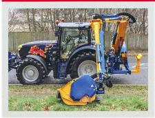
Les organes hydrauliques sont normalement alimentés en huile à partir du réservoir embarqué. On a ainsi la garantie d'un système hydraulique entièrement conçu en fonction des besoins de l'appareil, système de refroidissement compris. Ce dernier est à entraînement hydraulique ou électrique. Une commande électrique du rotor est disponible en option.
