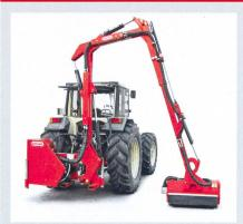
A l'aide d'un bras articulé à deux ou trois segments, on peut faucher l'herbe de l'autre côté d'une clôture. Lors d'un mandat d'entretien de la voirie au sens large, on est souvent amené à faucher ou broyer la végétation au-delà des clôtures ou des glissières de sécurité.
