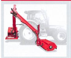
Parmi les «épareuses » professionnelles à montage arrière, les modèles les plus vendus sont ceux dont le balancier présente un déport vers l'avant. Ce déport, d'environ 1 mètre à compter des rotules des bras inférieurs du relevage arrière jusqu'à l'axe central du rotor, améliore la visibilité, et donc le confort de travail.
