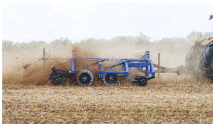
Le « Hektor Gigant » rabattable, avec une déchaumeuse large et plusieurs éléments segmentés, dispose de 55 couteaux par mètre de largeur de travail. Photo: IAT-Agrar
