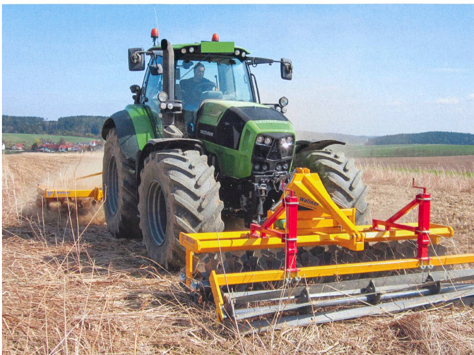
La double combinaison déchaumeuse et packer doubles disques travaille de manière particulièrement intensive, comme ici dans une dérobée gelée. Photo: Klaus Wallner Maschinenbau
