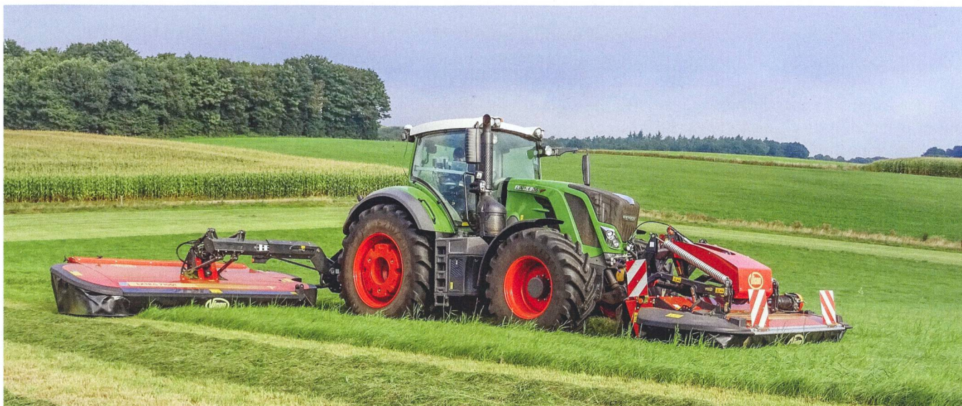
Kverneland/Vicon étendent l'usage du travail localisé par GPS baptisé « Section Control » à leurs machines de récolte de fourrages, comme ici sur la faucheuse papillon « Extra 7100 T ». Photos: Roman Engeler
