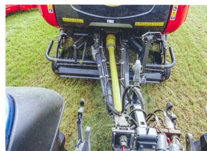
Un timon hydraulique à orientation automatique facilite le pilotage de la presse avec des andains irréguliers ou en courbe.
