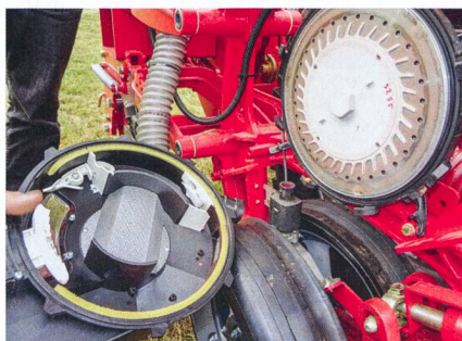
L'élément semeur à surpression des semoirs «Optima SX» permet une séparation très rapide des graines.
