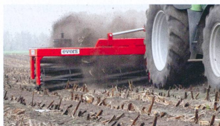
Les déchaumeuses à disques doubles partagent en deux la distance entre les couteaux. A l'image, le «Furioso» de Evers-Agro. Photo: Evers-Agro
