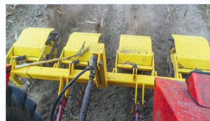
Le «broyeur à chaumes de maïs» de IK-Maschinenbau partage horizontalement les chaumes de maïs en morceaux de 20 mm jusqu'à la racine. Photo: IK-Maschinenbau
