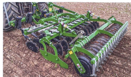
Un Crossboard antérieur, des disques agressifs et un réglage de l'angle d'attaque de 0-25° caractérisent le « X-Press VX » de Great-Plains (Simba). Photo: Great-Plains
