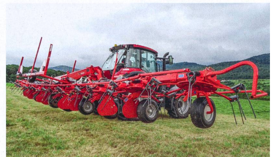
Cinématique de levage de la faneuse pirouette « GF 1018 »: toutes les toupies sont soulevées simultanément à la même hauteur.
