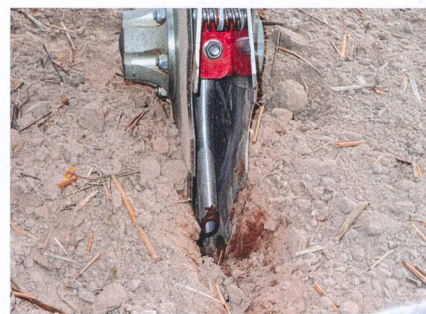
Avec un tank monté à l'avant, le semis au semoir «Optima» peut être combiné avec un apport de fertilisant liquide.
