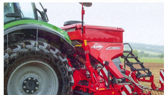
« Venta 3020 HR »: combinaison de semis avec herse rotative et soc à double disque. Presque tous les réglages peuvent être faits à partir du tracteur.
