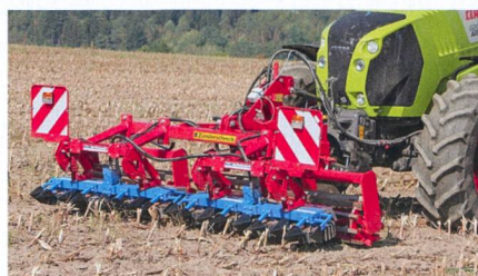
Le dispositif «Zünslerschreck-Aktiv» de Knoche est ici utilisé avec le système de rouleau abrasif de l'entreprise Bass-Antriebsttechnik. Photo: Knoche
