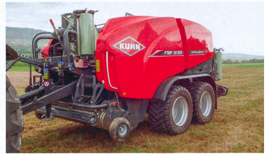
Le liage de film breveté de la « i-Bio+ » trouve à présent également sa place dans la nouvelle presse enrubanneuse combinée « FBP 3135 ».
