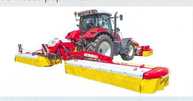
Avec la « Novacat A9 », Pöttinger élargit sa palette de faucheuses papillons. Cette combinaison d'unités de 3 ou 3,5 mètres, une frontale et deux arrière latérales, peut faucher des bandes jusqu'à, respectivement, 8,92 ou 9,18 mètres de large, avec des positions d'attelage correspondantes. Cette machine dispose d'un solide bâti
