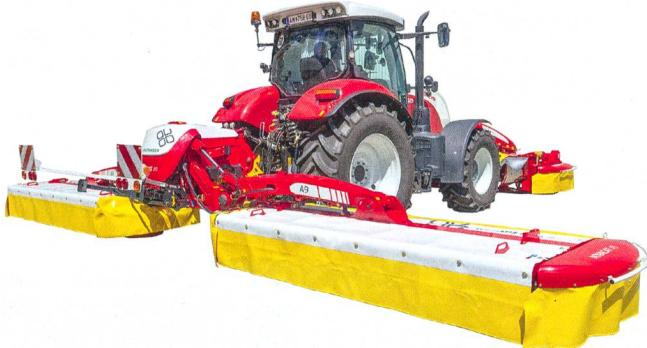
Avec la « Novacat A9 », Pöttinger élargit sa palette de faucheuses papillons. Cette combinaison d'unités de 3 ou 3,5 mètres, une frontale et deux arrière latérales, peut faucher des bandes jusqu'à, respectivement, 8,92 ou 9,18 mètres de large, avec des positions d'attelage correspondantes. Cette machine dispose d'un solide bâti
