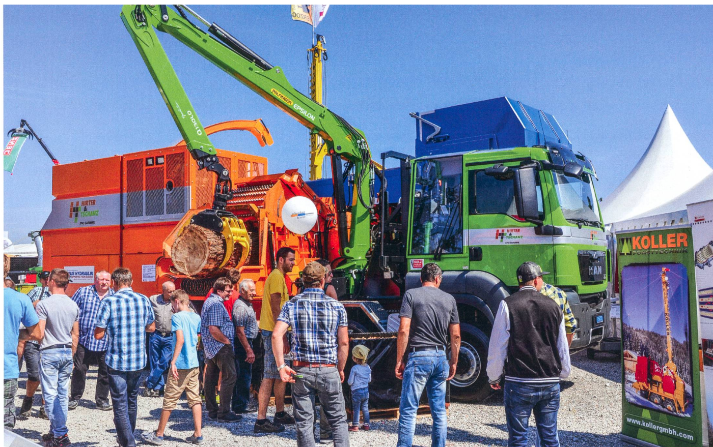
Les déchiqueteuses à tambour sont relativement peu encombrantes et conviennent bien pour une utilisation mobile. Photo : Ruedi Hunger
