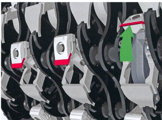
Le rotor de Komptech possède une protection contre les intrus, qui fait basculer le lamier tout entier vers l'arrière en cas d'introduction d'un corps étranger. Photo : Komptech
