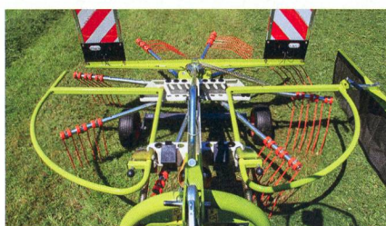
Ce modèle utilise la même came lubrifiée à vie dans un boîtier hermétiquement fermé que les grands andaineurs de Claas.
