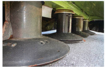
Les «Corto 310 F» ont quatre tambours de taille identique, chacun à trois couteaux, et un système d'échange rapide des couteaux.
