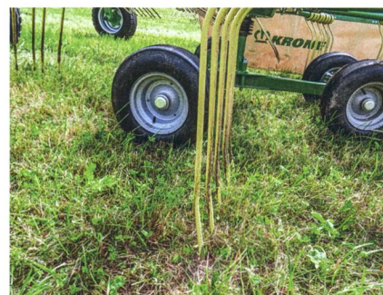
Les dents «Lift» présentent une courbure supplémentaire dans la partie inférieure.
