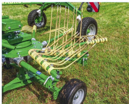
En option, on peut replier deux bras porte-dents, ce qui permet de réduire la hauteur de transport à environ 3 m...
