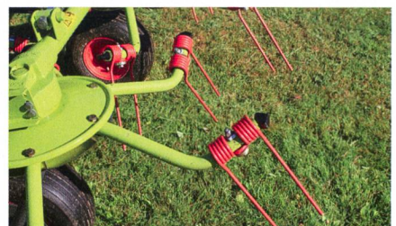
Les bras porte-dents sont coudés contre le sens de rotation. Cela permet à Claas de gagner 1 à 2 km/h de vitesse de travail.
