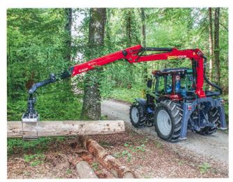
La grue «C60F86» de Palfinger a une portée de 8,6 mètres. Au moment où les photos ont été prises, le treuil était à l'atelier de réparation, raison pour laquelle il ne figure pas sur l'image.
