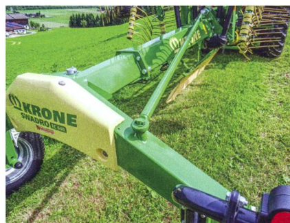
Sur demande, le chariot de transport peut être équipé d'un train d'attelage pivotant.
