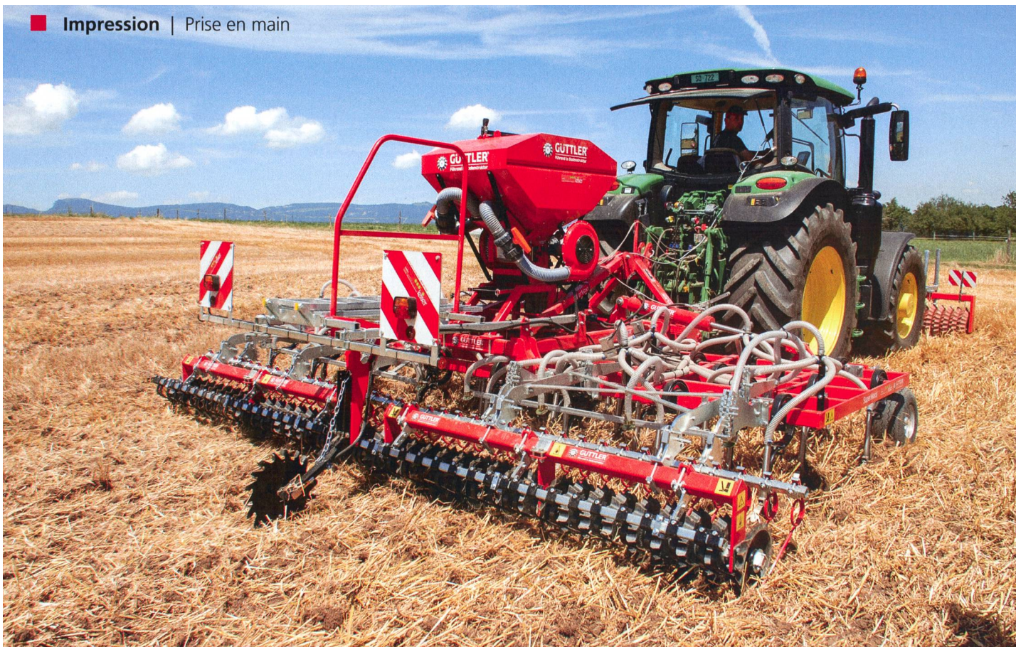
Travail du sol, désherbage, préparation du lit de semences, semis à la volée et en lignes: le «SuperMaxx» de Guttler offre de multiples usages.
