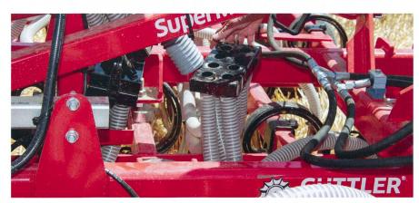
Les tuyaux de semis à la volée et en lignes peuvent être fixés au moyen d'un système à baïonnette.
