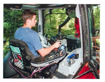
Le dispositif de conduite en poste inversé permet de pivoter le siège de 180° lorsqu'on travaille avec la grue. Celle-ci se commande avec les mêmes joysticks que ceux servant à piloter le tracteur.
