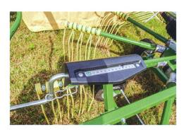
La hauteur de travail se règle avec une manivelle, elle se lit facilement sur une échelle.
