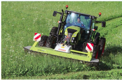
Les faucheuses à tambour travaillent quelles que soient les conditions et forment un andain étroit avec le fourrage.
