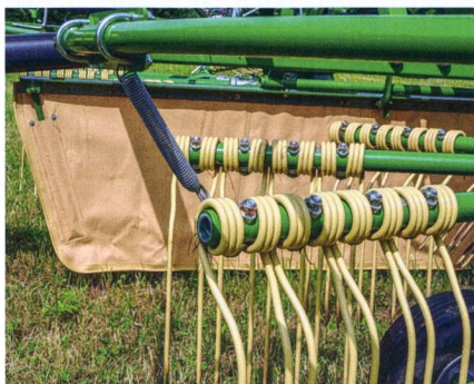
En version standard, le bras porte-dents est muni de trois dents, mais une place est prévue pour la quatrième dent.
