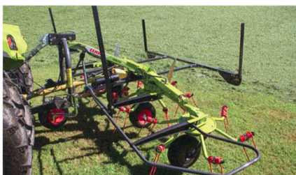
Deux stabilisateurs à ressorts assurent automatiquement le centrage de la faneuse lorsqu'elle est relevée.
