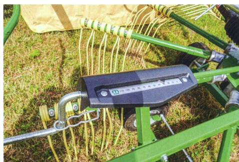
La hauteur de travail se règle avec une manivelle, elle se lit facilement sur une échelle.
