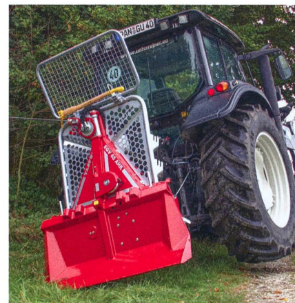
Grâce à un appareil patenté de surveillance de l'inclinaison, le renversement de tracteurs forestiers avec treuil peut être évité.
