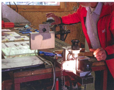
Grâce à cet appareil optique, les participants ont pu optimiser l'angle du tranchant des gouges de chaînes de tronçonneuses.
