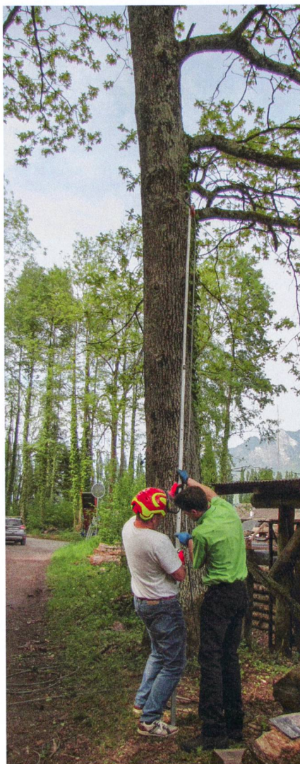
On peut mettre en place un câble rapidement et en toute sécurité à l'aide d'une perche télescopique.
