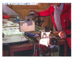
Grâce à cet appareil optique, les participants ont pu optimiser l'angle du tranchant des gouges de chaines de tronçonneuses.
