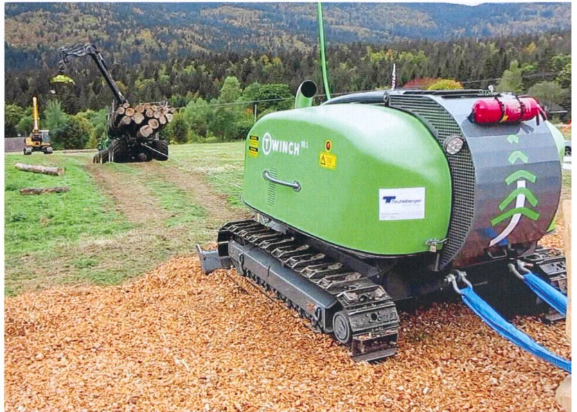
Ecoforst a choisi une voie qui lui est propre. Son treuil de traction externe se monte sur un porteur spécialement créé. Photo : Ecoforst
