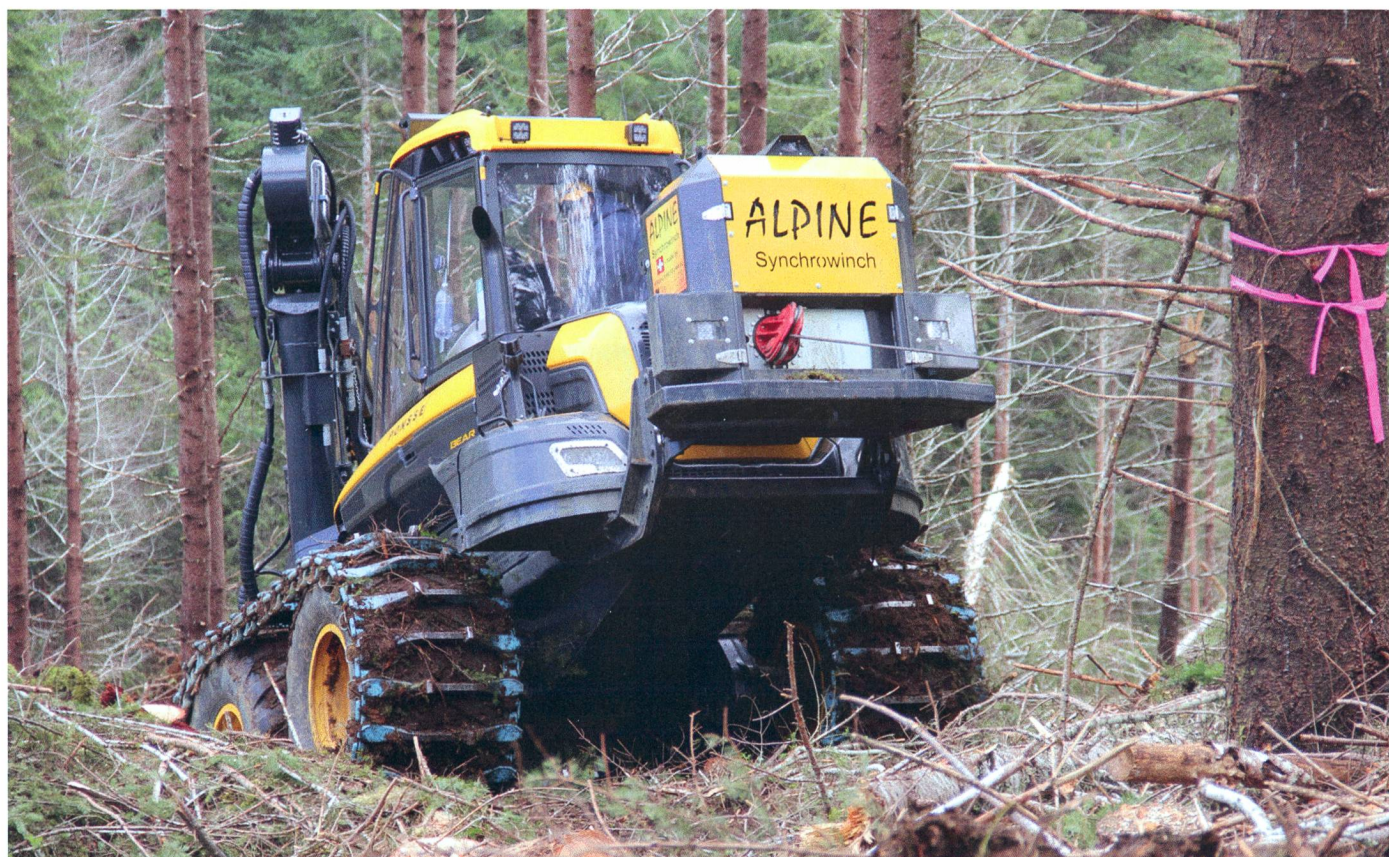
Les treuils synchronisés fixes et intégrés sont toujours prêts à l'usage. Mais ils alourdissent considérablement le véhicule. Photo: Herzog
